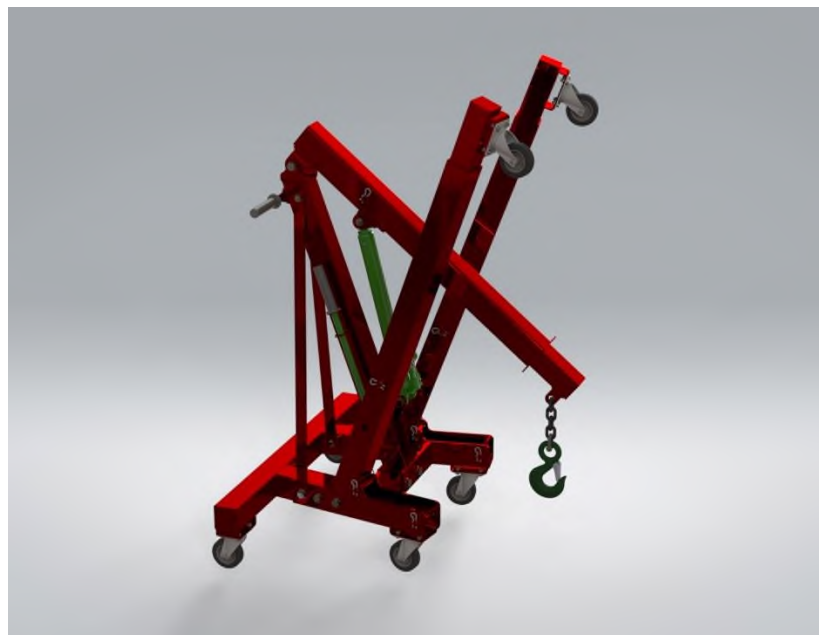
Рис. 2.6. Кран підкатний гідравлічний у складеному положенні
