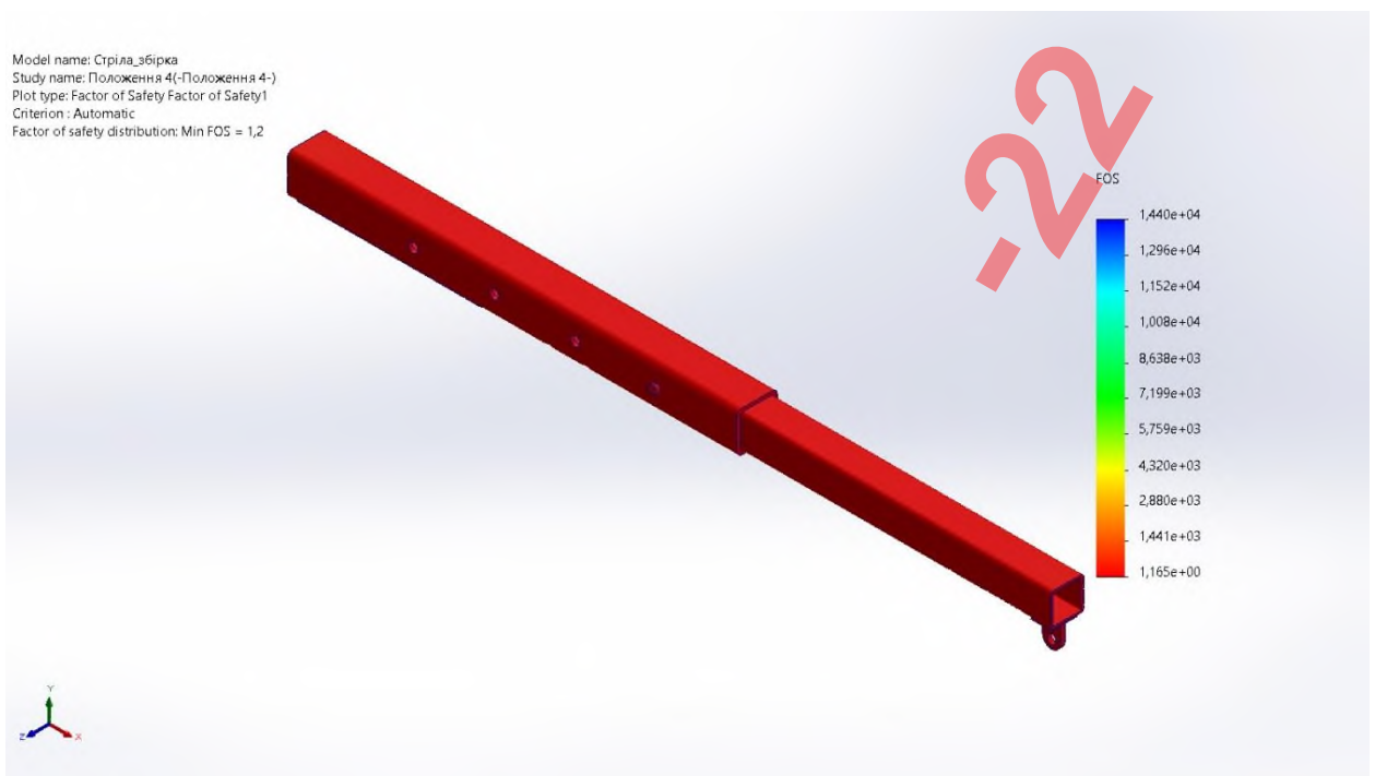
Рис. 3.7. Епюра коефіцієнта запасу міцності для положення 4 ( P = 5000 Н)
