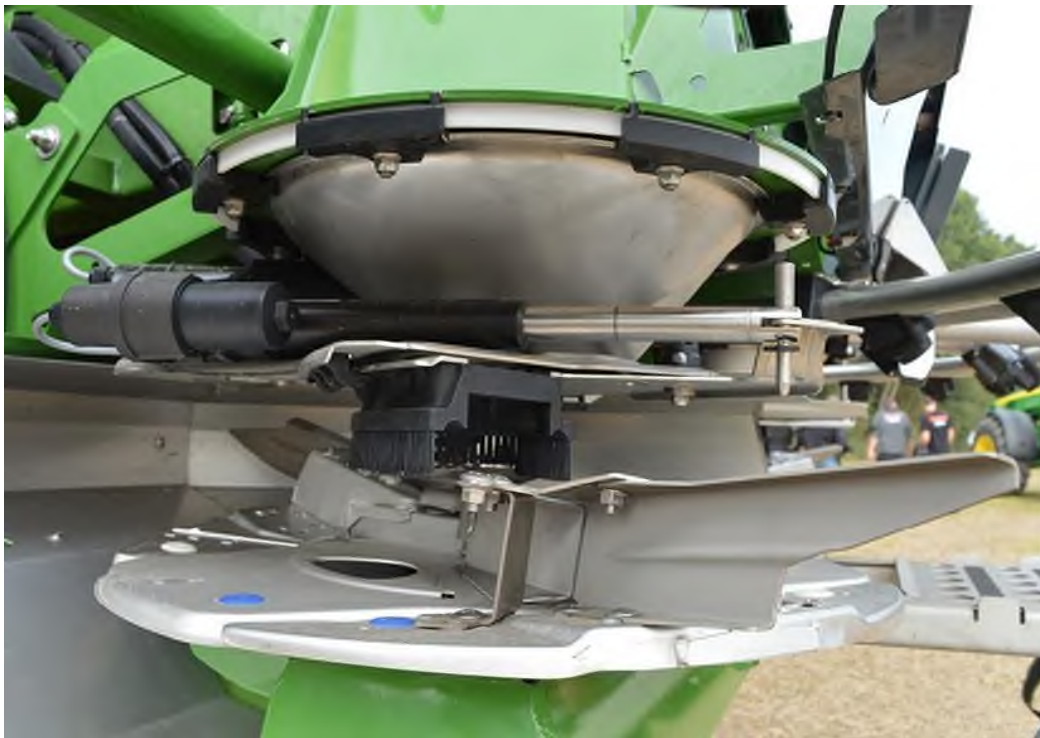
Рис. 1.1 - Навісний відцентровий розкидач мінеральних добрив з одним тукорозсівним апаратом дискового типу
