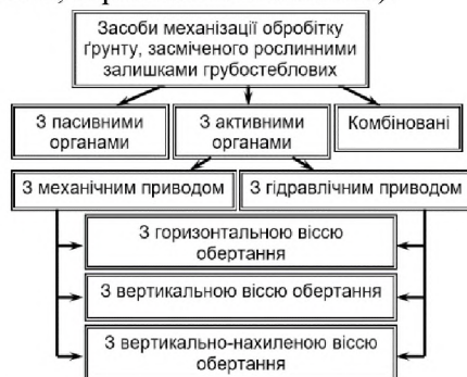
Рис. Схема класифікації основних засобів обробітку ґрунту, засміченого рослинними залишками грубостеблових культур
