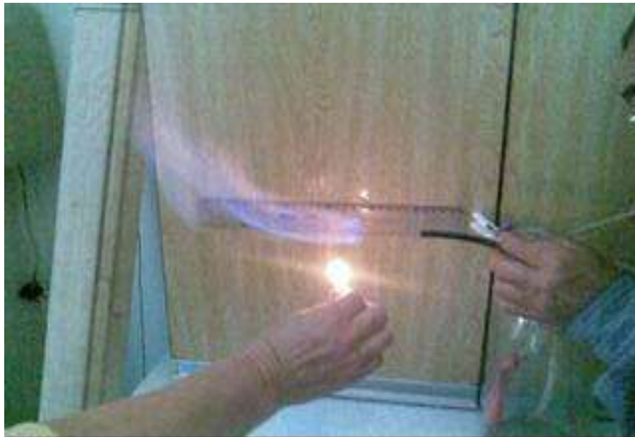
Рис. 3.15. Горіння очищеного біогазу
