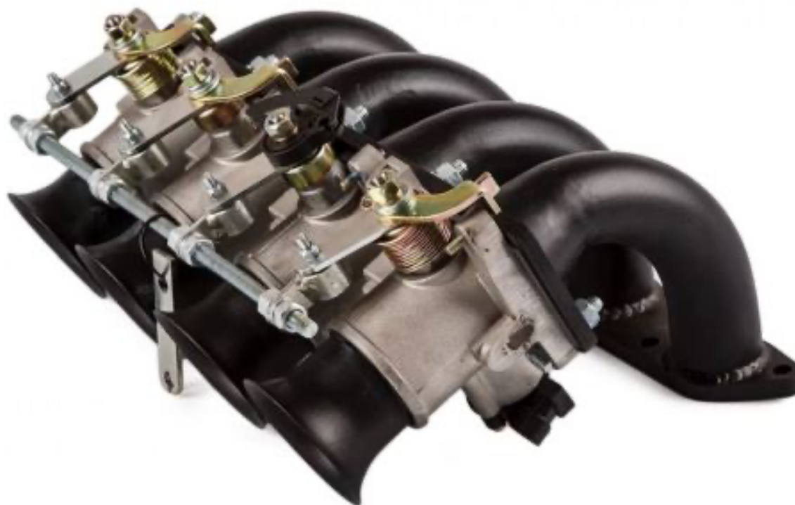
Рисунок 1.2. Система впуску ДВЗ з дроселем на кожен циліндр
