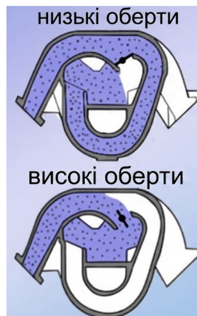
Рисунок 1.3. Впускний колектор з каналами фіксованої довжини
