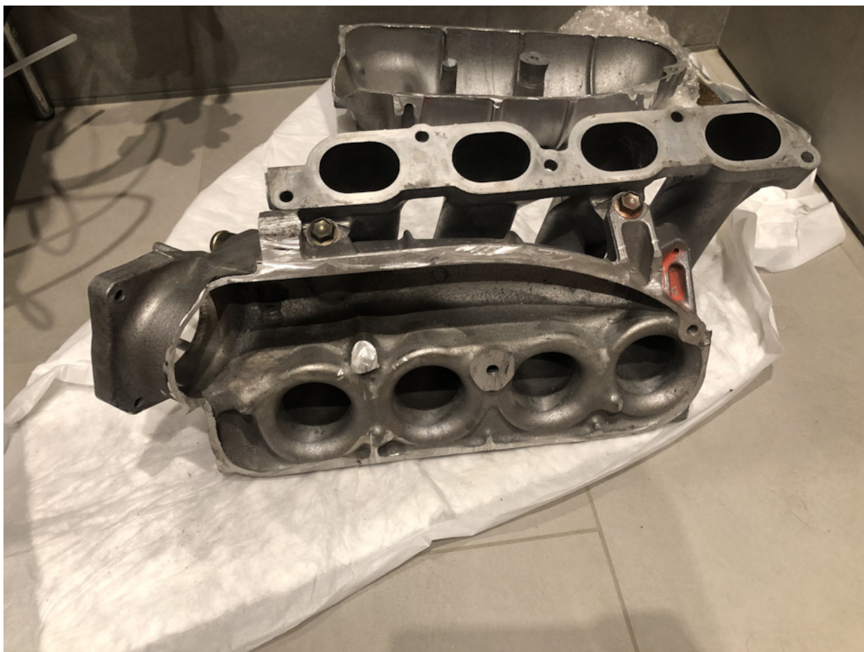
Рисунок 1.5. Впускний колектор з внутрішніми раструбами на кожен канал
