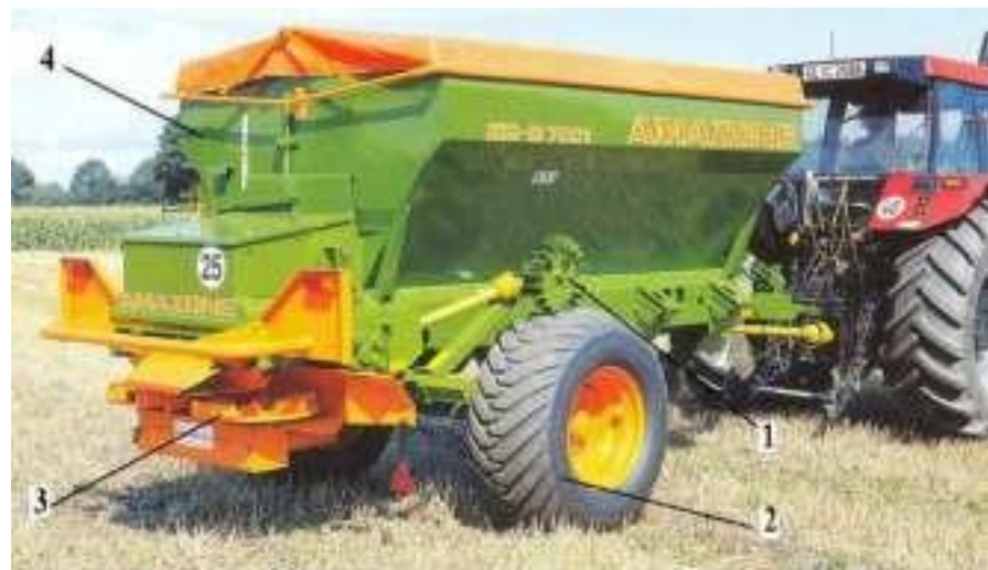
Рисунок 1.5 - Розкидач мінеральних добрив кузовного типу ZG-B 7001: 1 – привідний ролик; 2 – опорне колесо; 3 – дводисковий розкидач; 4 – кузов
