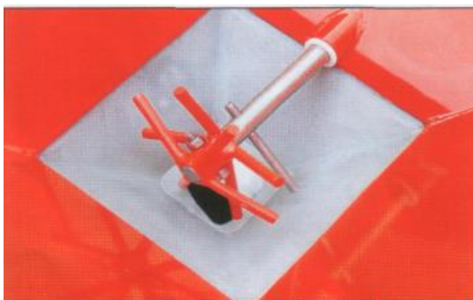
Рисунок 1.2 - Розкидач бункерний начіпний ЕК-301, оснащений однодисковим тукорозкидачем: 1 – диск; 2 - бункер
