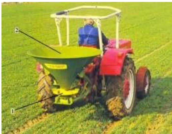
Рисунок 1.2 - Розкидач бункерний начіпний ЕК-301, оснащений однодисковим тукорозкидачем: 1 – диск; 2 - бункер
