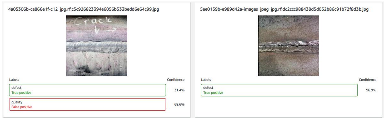
Рисунок 2.9 Результат визначення дефекту методом машинного зору (наявність тріщини що розташована в зоні термічного впливу при недостатній кількості схожих варіантів в тренувальному наборі даних може призвести до появи False positive для такого зображення)
