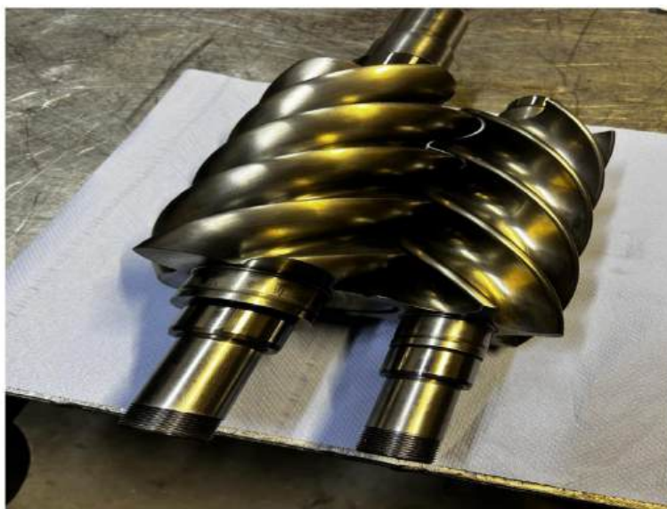
Рис.2.2 Неконтрольований знос компресорного блока
