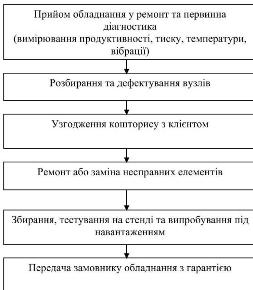
Рис.2.4 Схема технологічного процесу ремонту компресорів у ТОВ «Проейр Захід»
