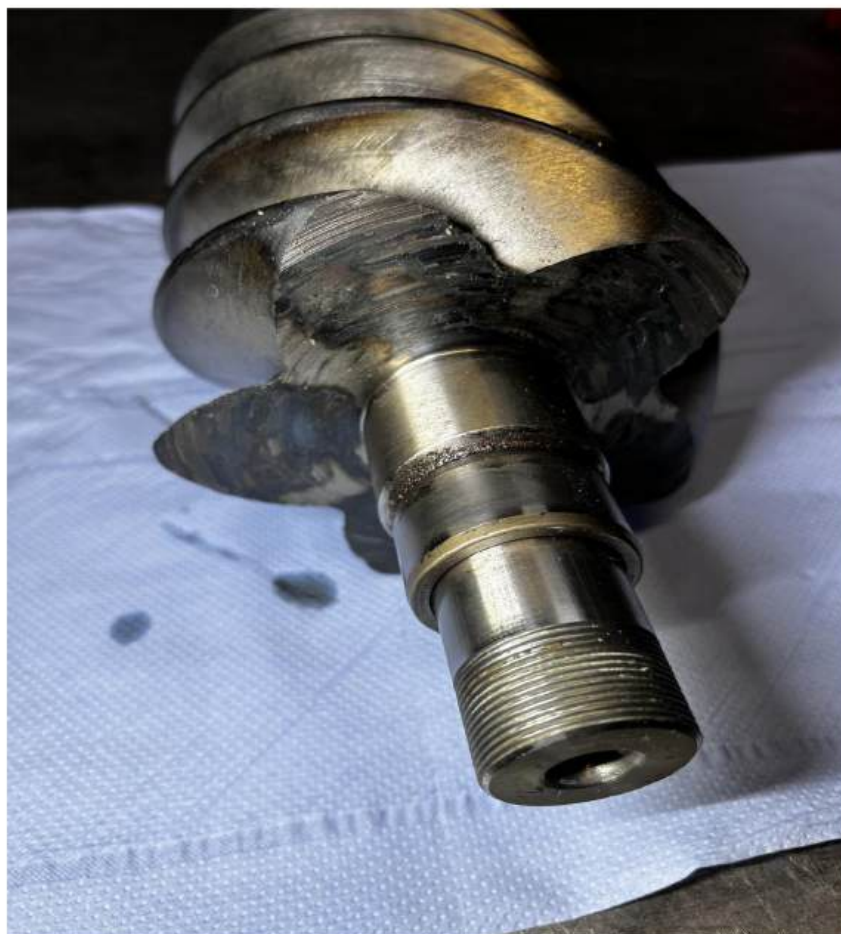
Рис.2.3 Аварійне пошкодження гвинта та посадкового місця підшипників
