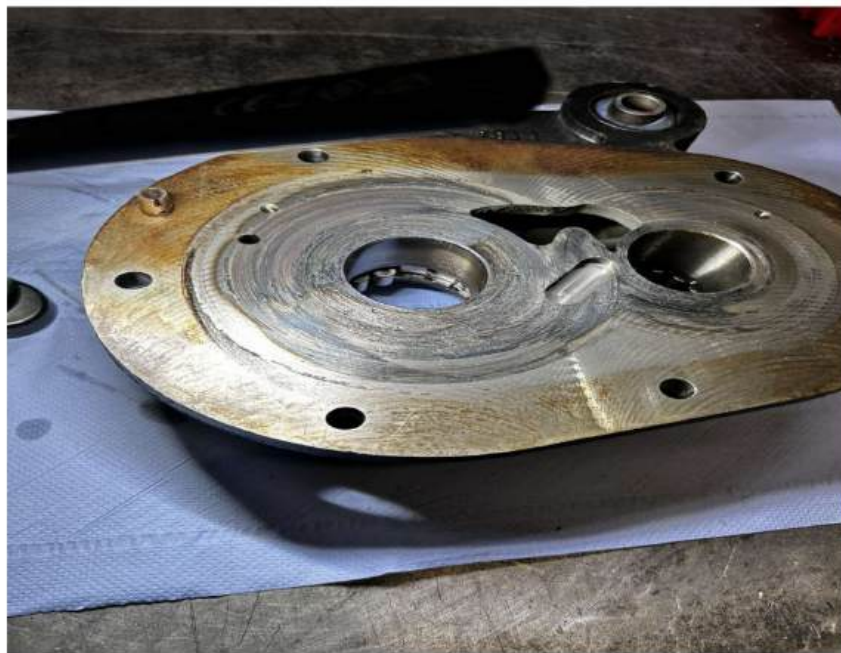
Рис.3.3 Спрацювання площини поверхні кришки корпусу компресора
