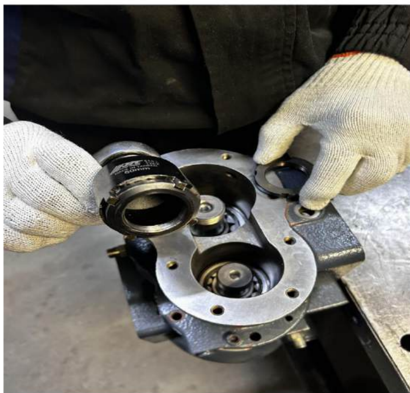
Рис.2.1 Поява задирів на роторах та гільзах підшипників, руйнування підшипників
