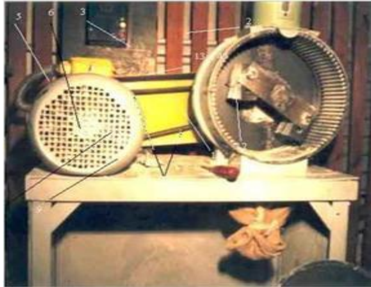
Рисунок 3.6 - Лабораторне місце для дослідження процесу подрібнення на дослідному малогабаритному подрібнювачі: 1 - живильний патрубок; 2 - шиберна заслінка; 3 - корпус; 4 - кришка подрібнювальної камери; 5 - захисний кожух; 6 - клинопасова передача; 7 - електродвигун; 8 - рама; 9 - стійки рами; 10 - відвідний патрубок; 11 - ніжки рами; 12 - опорний фланець подрібнювальної камери; 13 - стопорне кільце; 14 - палець; 15 - планки ротора; 16 - молотки; 17 - маточина ротора; 18 - прилад К - 50; 19 - ваги лабораторні
