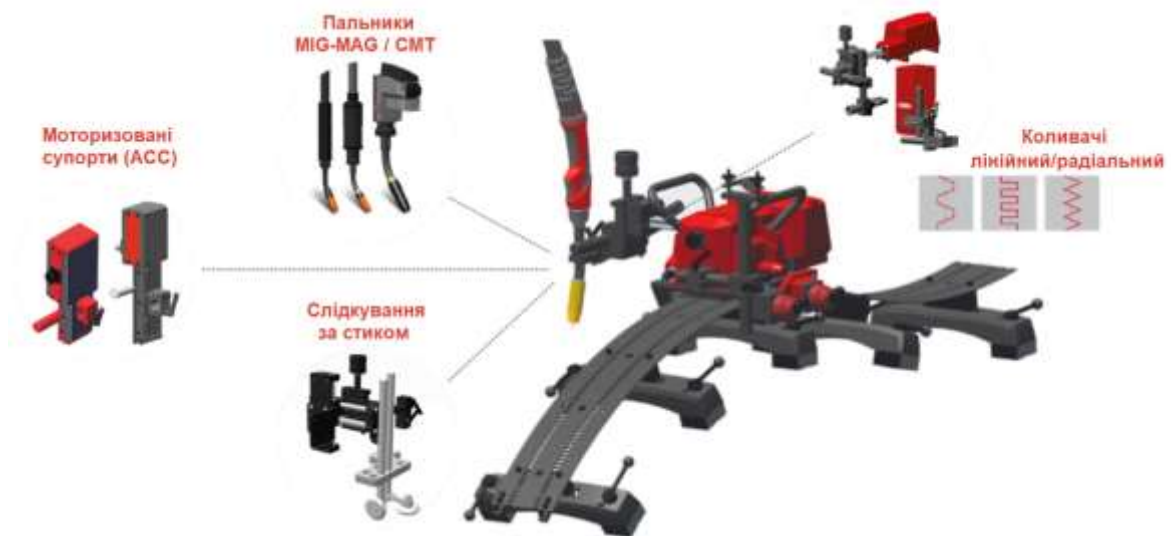
Рисунок 3.8 – Функціональні особливості зварювального візка FlexTrack 45 Pro
