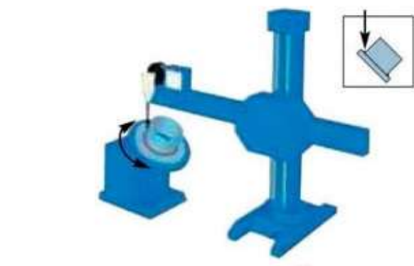
Зварювання спільно із зварювальними обертачами
