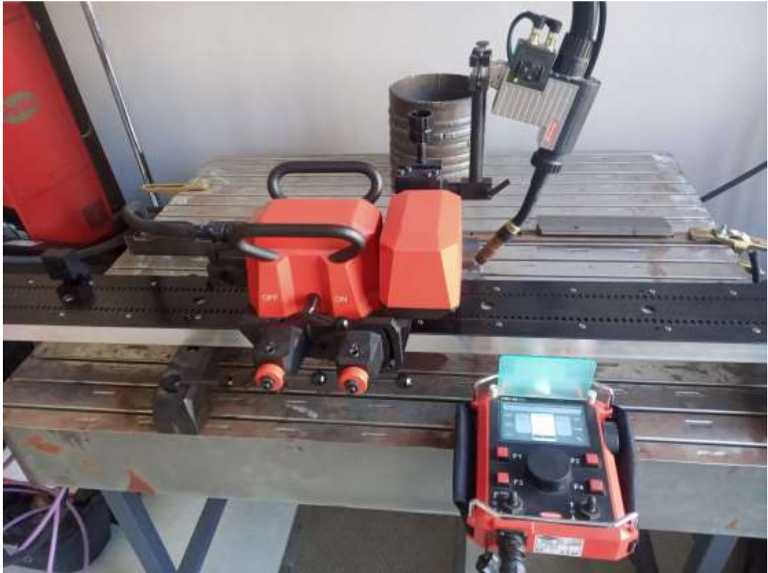
Рисунок 3.2 – Візок FlexTrack 45 Pro для переміщення пальника з пристроєм маятникового коливання FOU 30/ML10 та пультом керування FRC-45 Pro
