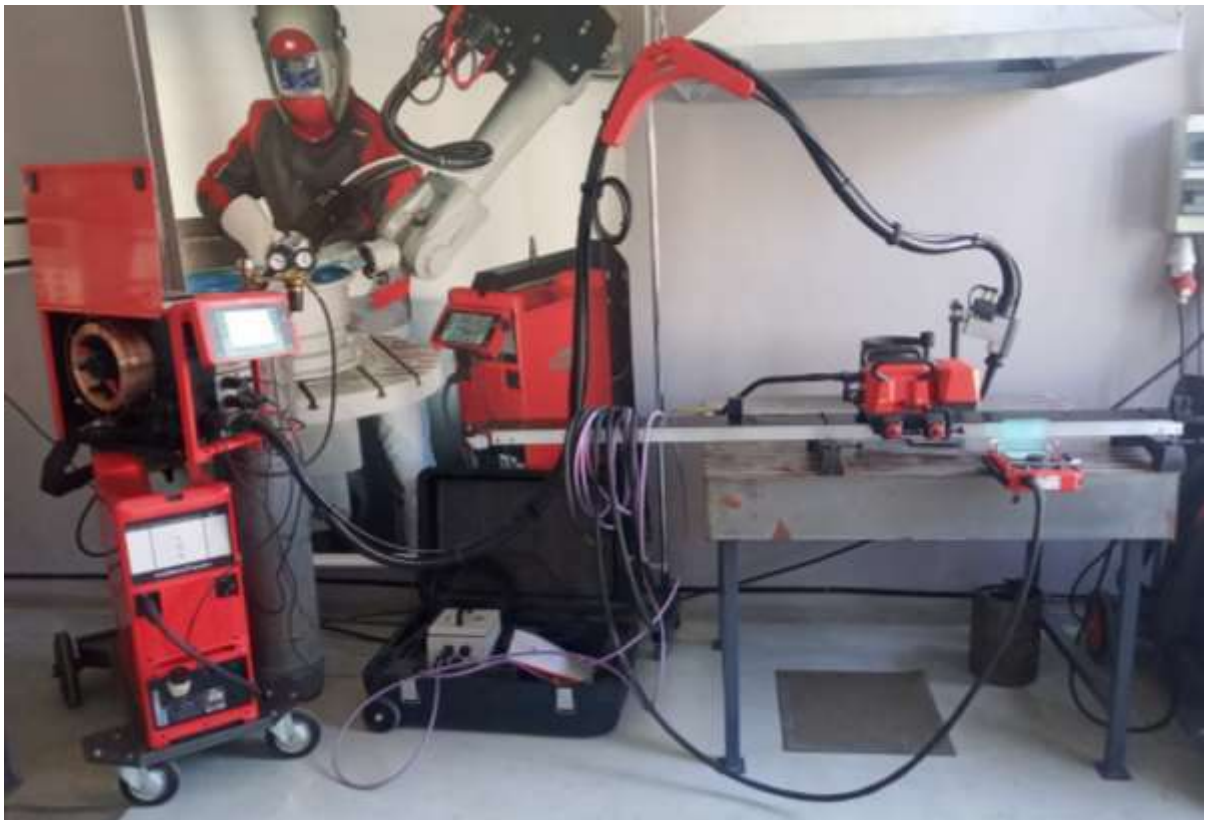
Рисунок 3.1 – Загальний вигляд зварювальної установки для наплавлення
