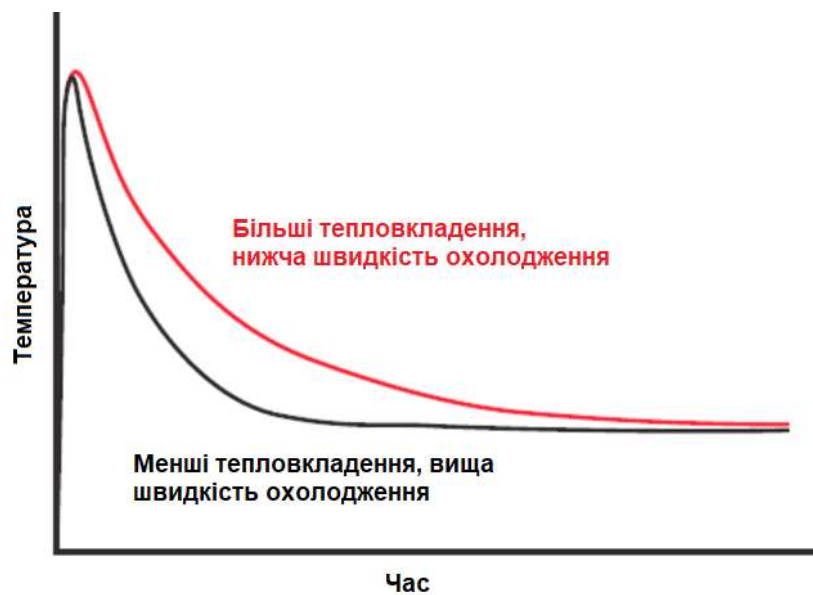
Рисунок 2.7 – Графіки впливу тепловкладень на швидкість охолодження
