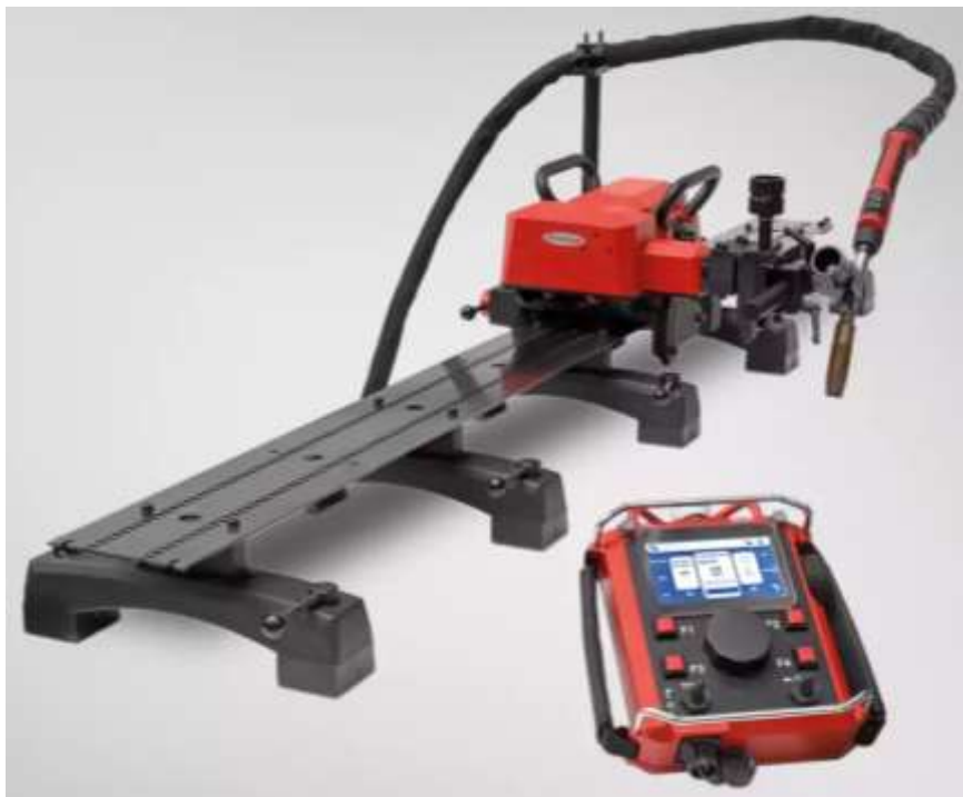
Рисунок 3.7 - Зварювальний візок FlexTrack 45 Pro для орбітального зварювання
