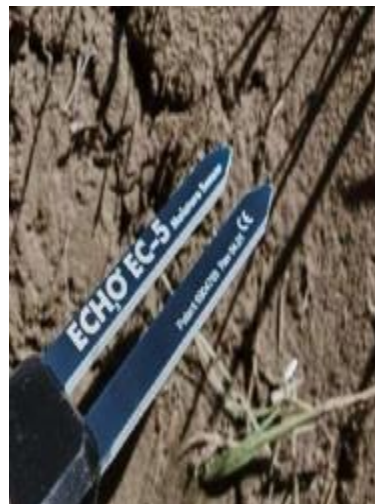
Рисунок 3.9 – (а) Контроль зберігання та подачі води, (б) датчик вологості ґрунту.
