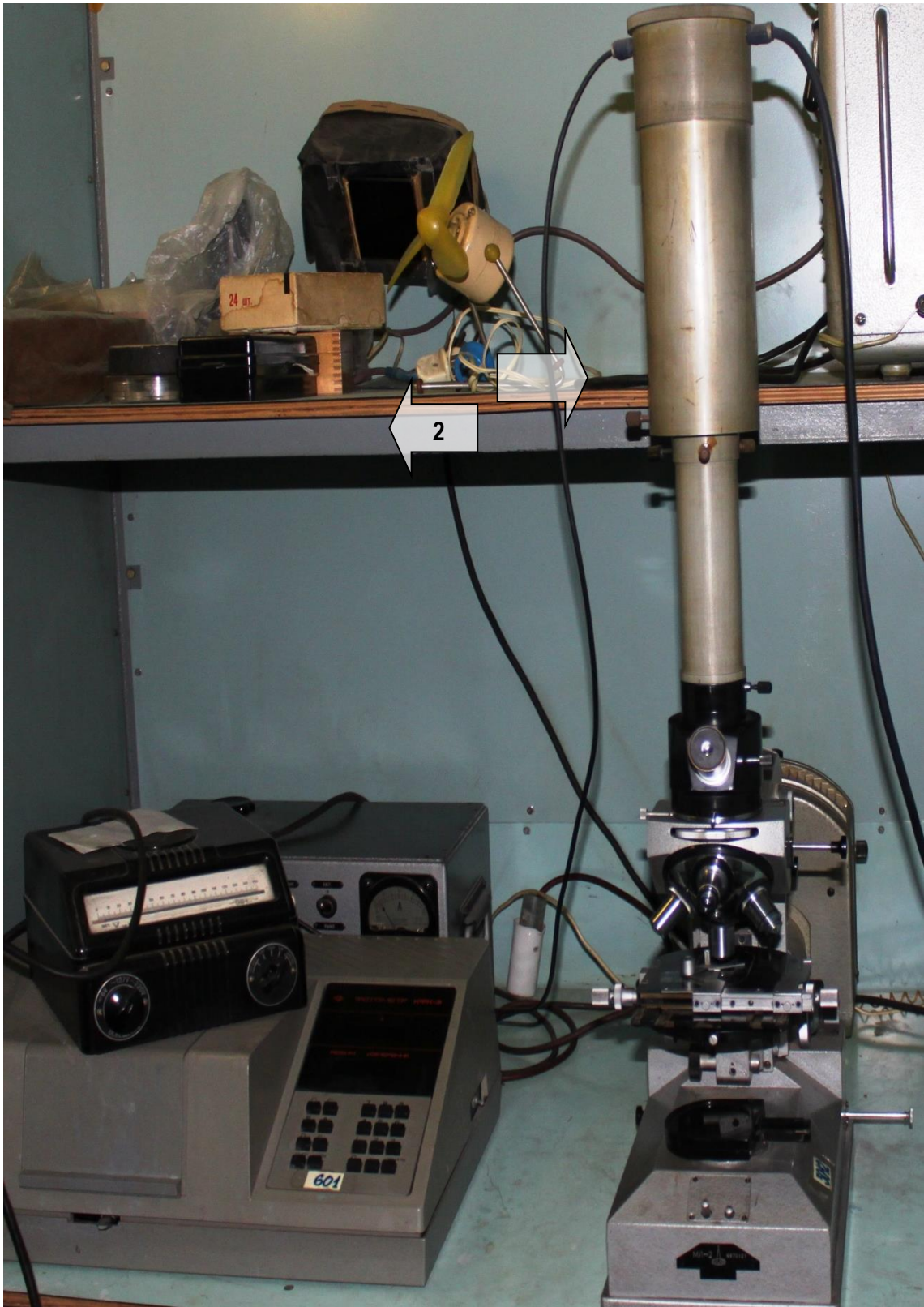
Рис. 2.4. Люмінесцентний мікроскоп (1), дообладнаний лічильником фотонів (2) для реєстрації інтенсивності флуоресценції листків.
