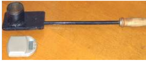
Рисунок 3.6 - Обладнання для визначення щільності ґрунту
