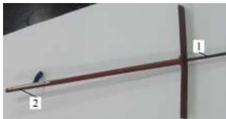
Рисунок 3.7 - Глибиномір: 1 – рухомий штир; 2 – лінійка.
