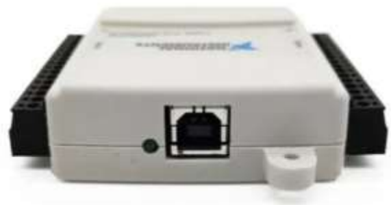
Рисунок 3.3 – National Instruments USB-6008 - блок вводу-виводу інформації (аналого-цифровий перетворювач (АЦП)).
