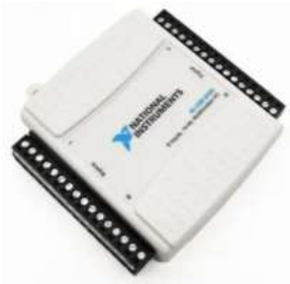
Рисунок 3.3 – National Instruments USB-6008 - блок вводу-виводу інформації (аналого-цифровий перетворювач (АЦП)).
