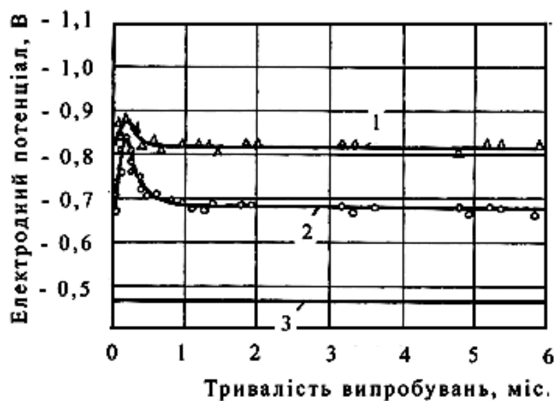
Рис. 3.1. Залежність величини електродного потенціалу від тривалості випробувань: 1 - Zn-покриття; 2 - Al-покриття; 3 - без покриття
