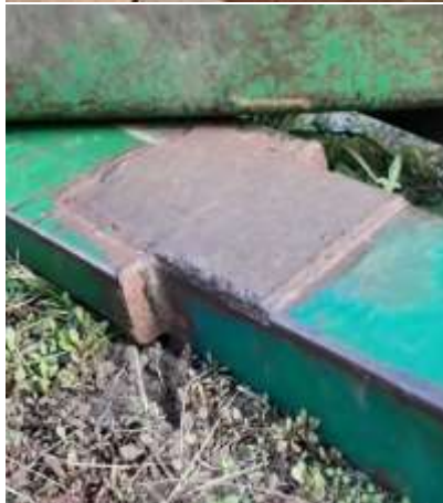
Рисунок 1.1 - Відновлення геометрії рами – а, деформовані та пошкоджені елементи рам, зварних швів та обладнання культиваторів - б
