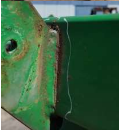
Рисунок 1.1 - Відновлення геометрії рами – а, деформовані та пошкоджені елементи рам, зварних швів та обладнання культиваторів - б
