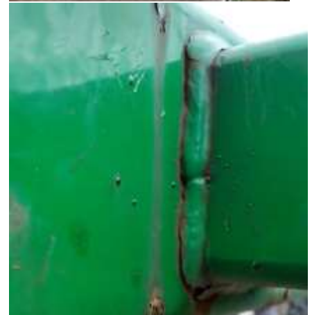
Рисунок 1.1 - Відновлення геометрії рами – а, деформовані та пошкоджені елементи рам, зварних швів та обладнання культиваторів - б
