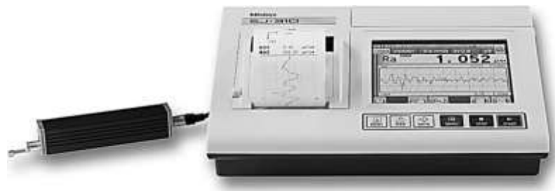
Рис. 3.9 - Портативний профілометр Mitutoyo Surftest SJ – 310
