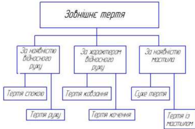
Рис. 2.1 – Класифікація видів зовнішнього тертя
