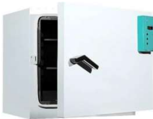
Рис. 3.3 - Сушильна шафа марки ШС — 80 — 01
