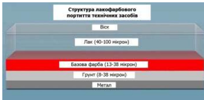
Рис. 1.1 - Структура лакофарбового покриття
