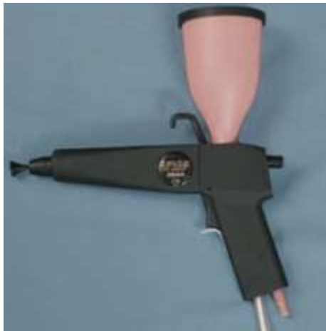
Рис. 3.2 - Електростатичний розпилювач — пістолет марки Старт — 50.
