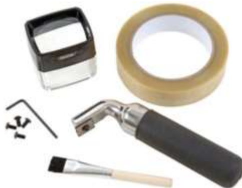
Рис. 3.5 - Тестер оцінювання адгезії Elcometer 107 .
