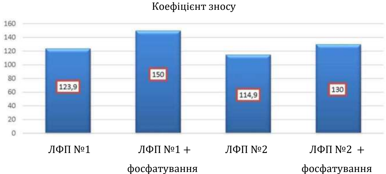
Рис. 4.5 - Порівняння зносостійкості лакофарбових покриттів ЛФП №1 та ЛФП №2
