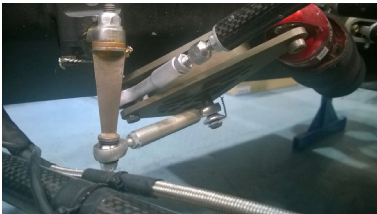
Рисунок 1.6 – Приклад конструкції коромисла (рокера) у зборі з тягами
