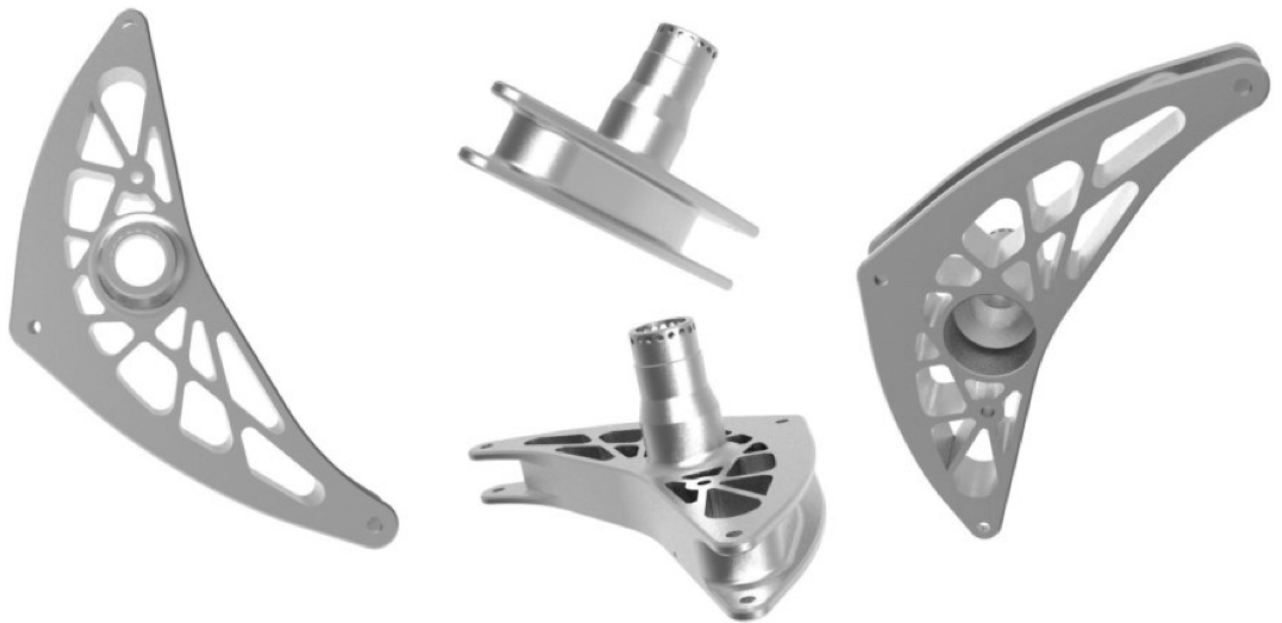
Рисунок 3.9 – 3D-модель розробленого коромисла (фінальний варіант)
