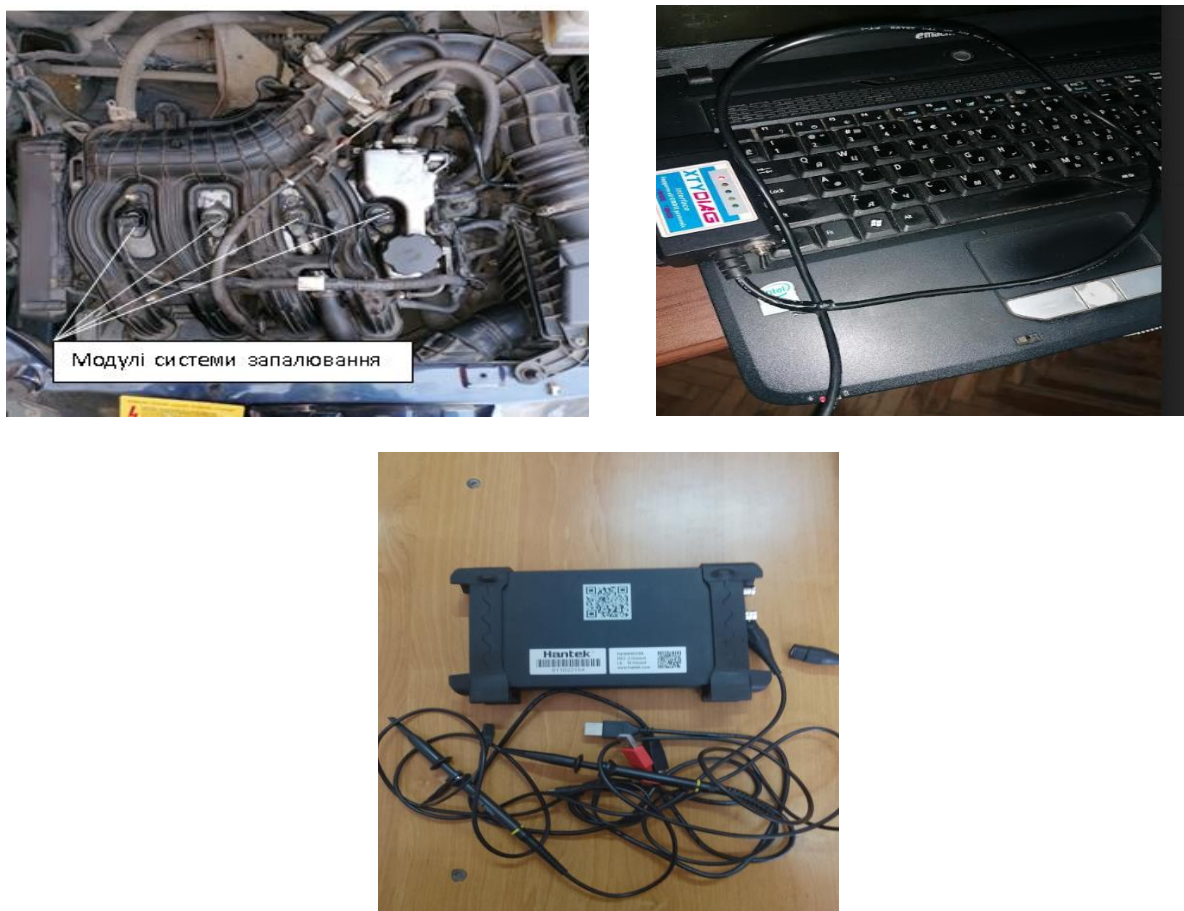
Рисунок 3.6 – Розміщення модулів системи запалювання та діагностичне обладнання (сканер «XTY DIAG» і осцилограф «Hantek»).
