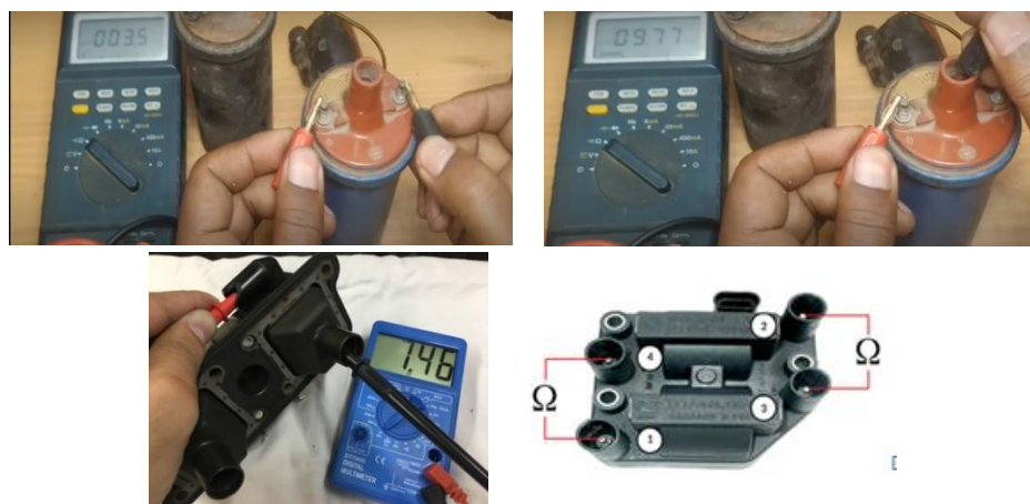
Рисунок 3.1 – Визначення технічного стану первинної обмотки і вторинної обмотки котушки запалювання (за допомогою мультиметра).
