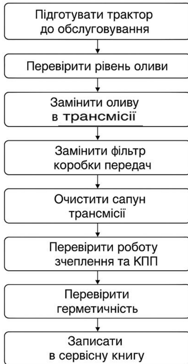
Рисунок 3.1 – Технологічна карта технічного обслуговування трансмісії трактора CLAAS ARION
