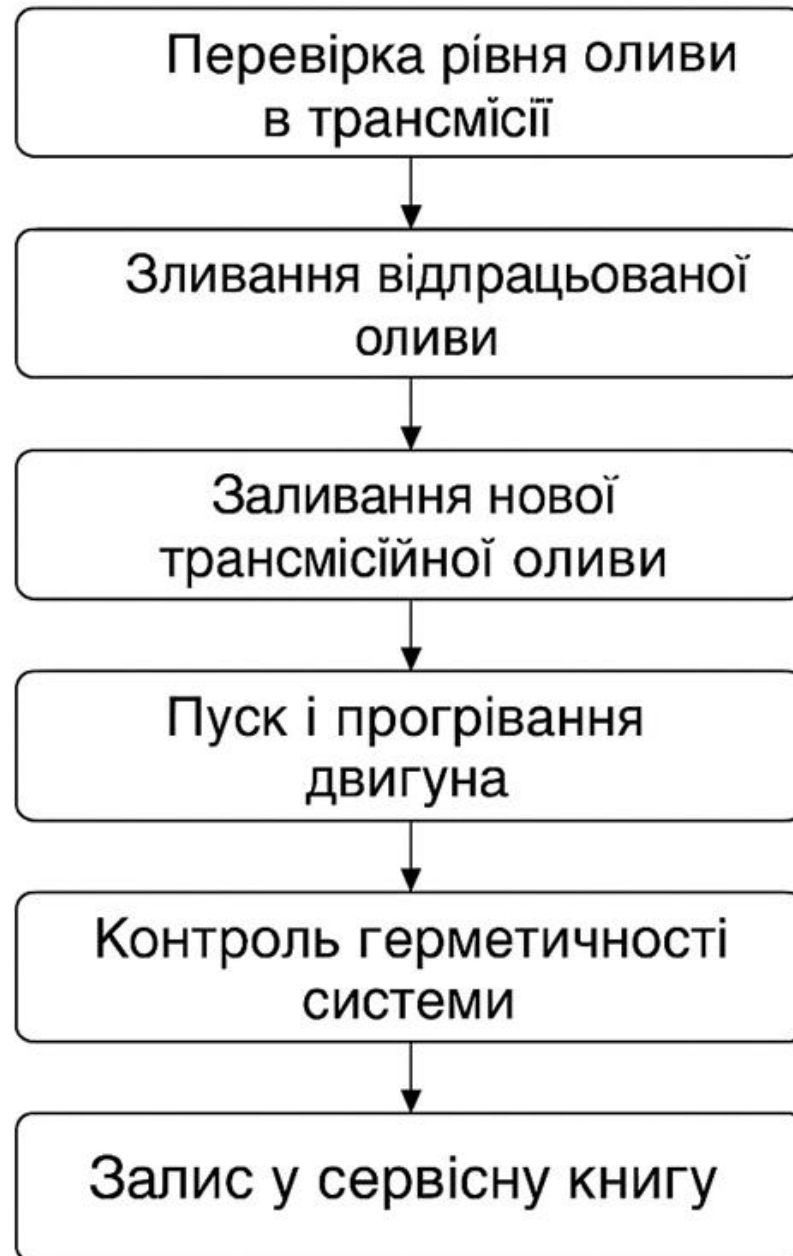
Рисунок 2.4 – Послідовність операцій технічного обслуговування трансмісії CLAAS AION
