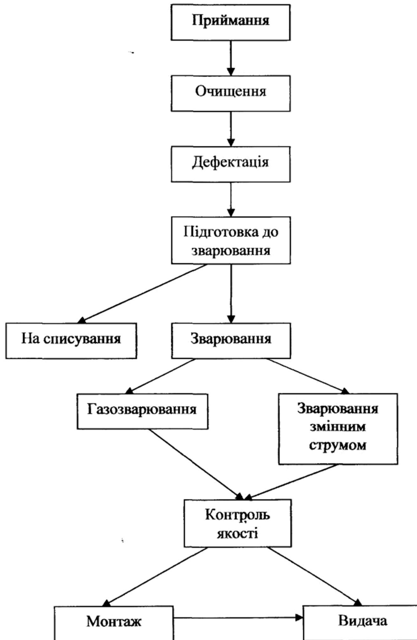
Рисунок 1.2 – Схема технологічного процесу зварювального відділення.
