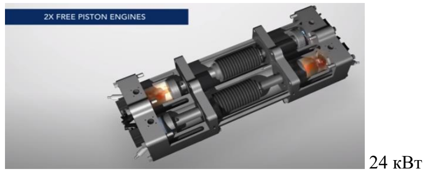
Рисунок 1.4 – Загальний вигляд та особливості приводу лінійного генератора [20].
