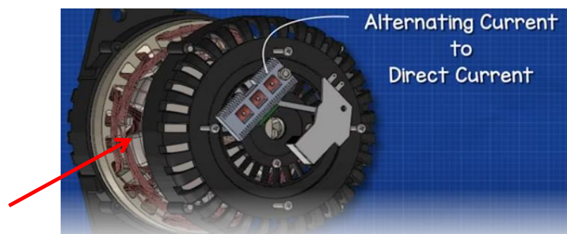
Рисунок 1.5 – Розміщення трьохфазного випрямляча у генераторній установці.
