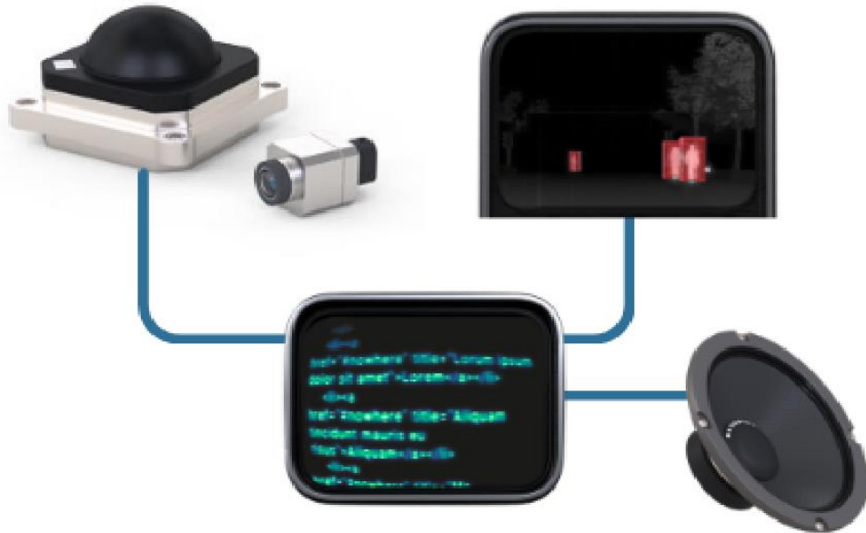
Рисунок 1.4 – Сенсори системи допомоги водієві ADAS.
