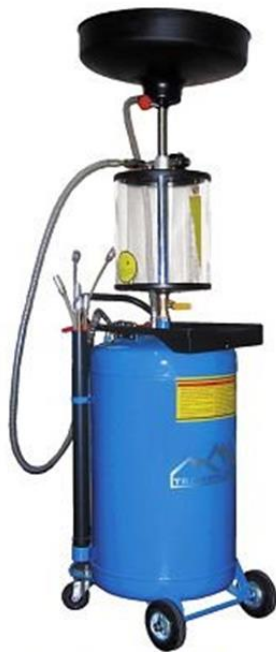
Рисунок 2.2 – Мобільна установка для збору олії Trommelberg UZM70
