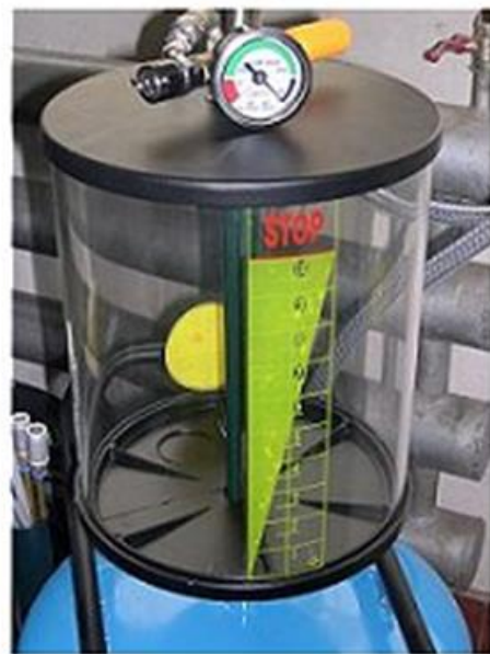
Рисунок 2.2 – Мобільна установка для збору олії Trommelberg UZM70
