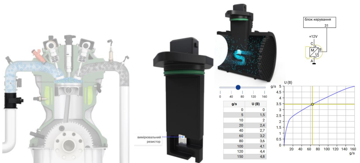
Рисунок 2.2 – Сенсор масовий витратомір повітря
