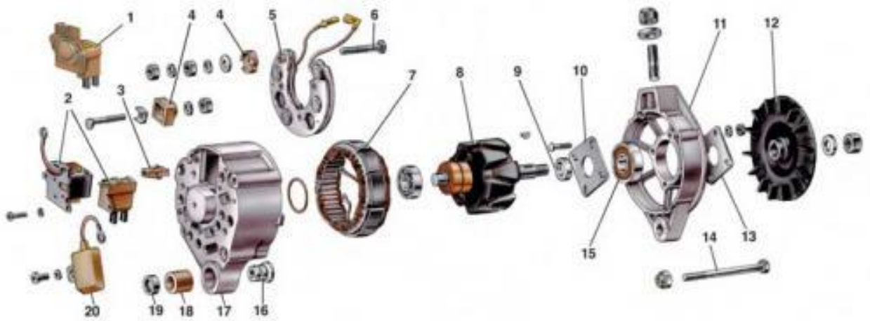
Рисунок 3.12 – Розбирання генератора: 1 – регулятор напруги зі щіткотримачем; 2 – регулятор напруги та щіткотримач; 3 – колодка додаткових діодів; 4 – ізолюючі втулки; 5 – випрямляч; 6 – контактний болт; 7 – статор; 8 – ротор; 9 – втулка; 10 – внутрішня шайба підшипника; 11 – кришка з боку приводу; 12 – шків; 13 – зовнішня шайба підшипника; 14 – стяжний болт; 15 – передній підшипник; 16 – втулка; 17 – кришка з боку контактних кілець; 18 – буферна втулка; 19 – підтискна втулка; 20 – конденсатор.
