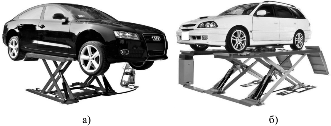
Рисунок 1.6 – Ножничний підйомник а) короткий платформа б) довгій платформі
