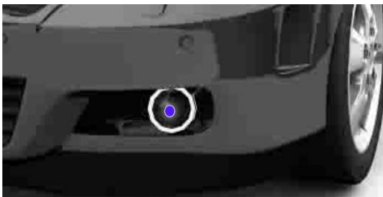
Рисунок 1.12 - Передня протитуманна фара
