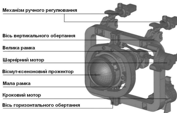
Рисунок 2.5 – Конструкція системи ASF
