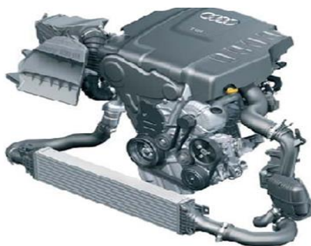
Рисунок 1.2 – Двигун Audi 2,0л TDI із системою Common Rail
