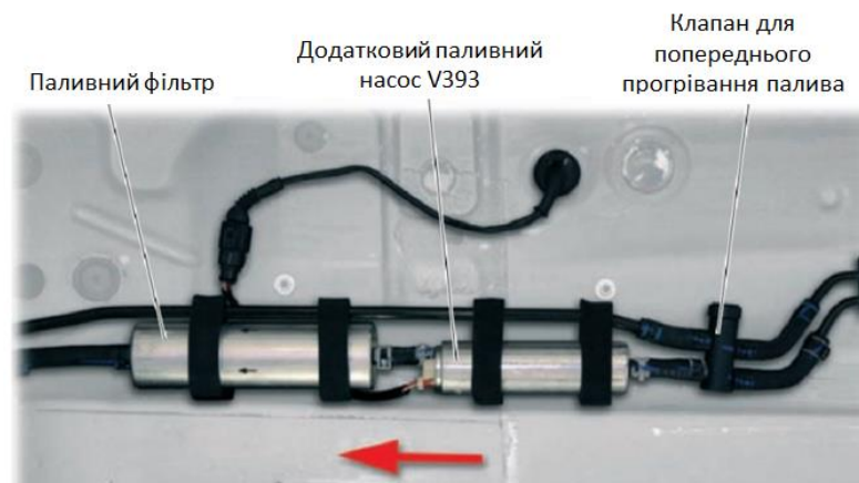
Рисунок 1.5 – Подача палива у магістралі низького тиску.
