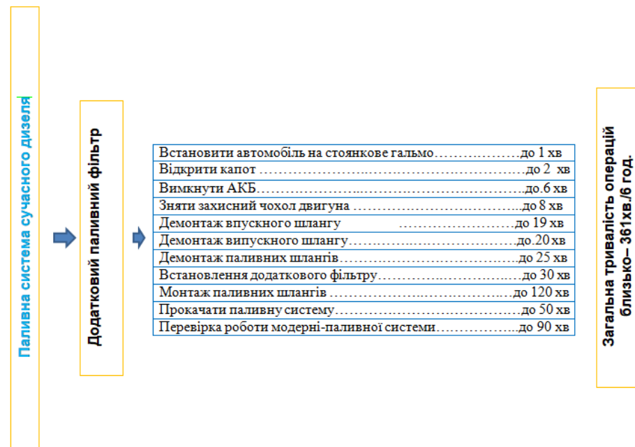
Рисунок 3.2 –Операційна карта на встановлення додаткового паливного фільтру у систему «Common Rail».
