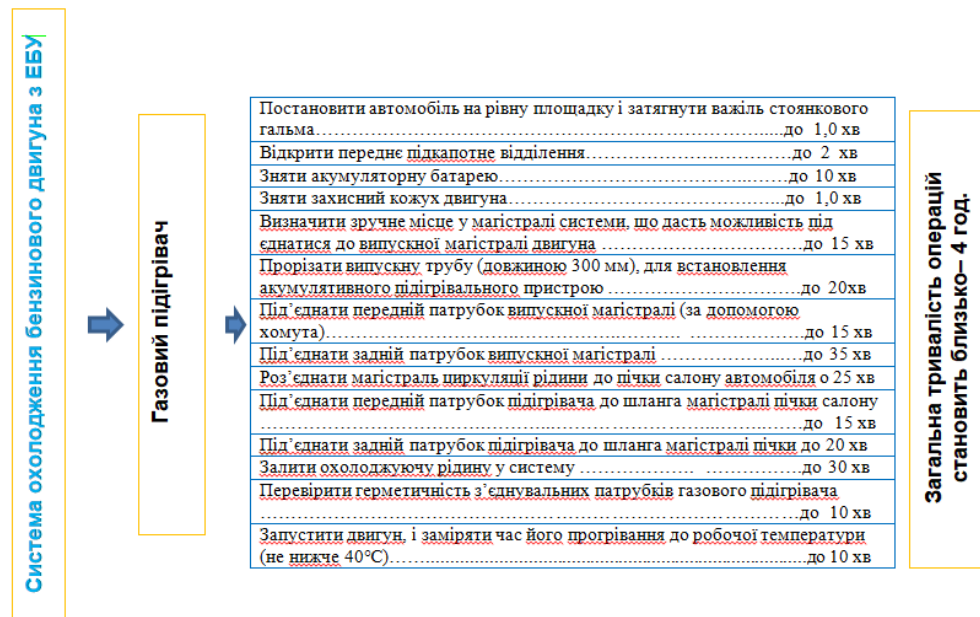
Рисунок 3.3 – Операційна карта на встановлення газового підігрівача у систему охолодження бензинового двигуна
