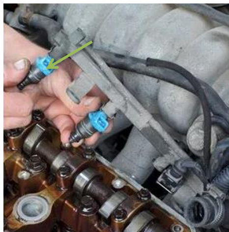
Рисунок 3.1 – Демонтаж неякісно працюючої паливної форсунки.
