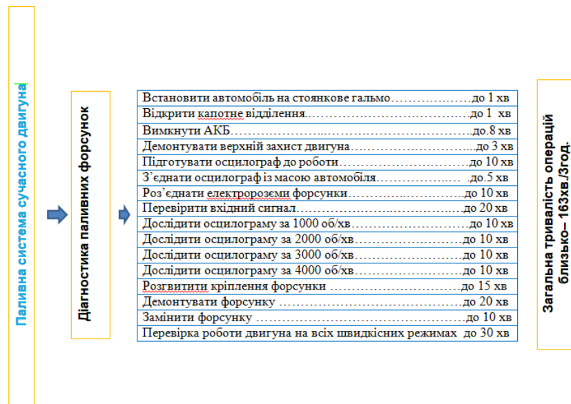
Рисунок 3.3 – Операційна карта на використання електронного осцилографу для проведення діагностичних робіт паливних форсунок двигуна.
