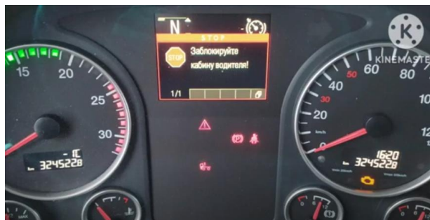
Рисунок 1.3 – Покази дисплея несправної роботи датчика фіксації кабіни автопоїзда MAN TGX.
