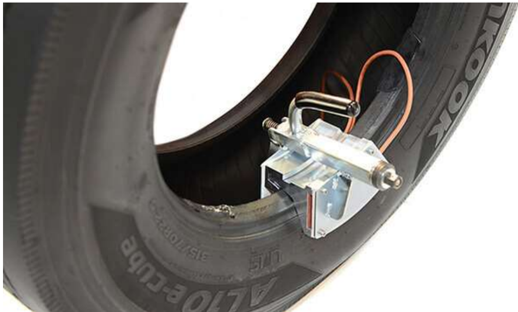
Рисунок 1.8 – Гарячий ремонт шини
