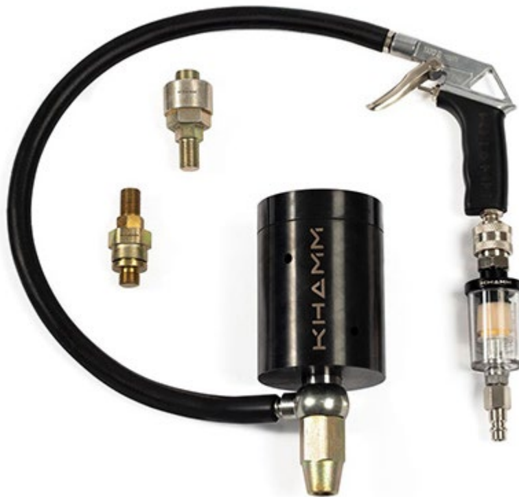
Рисунок 1.8. Пневматичний молоток для демонтажу дизельних форсунок КНАММ.
