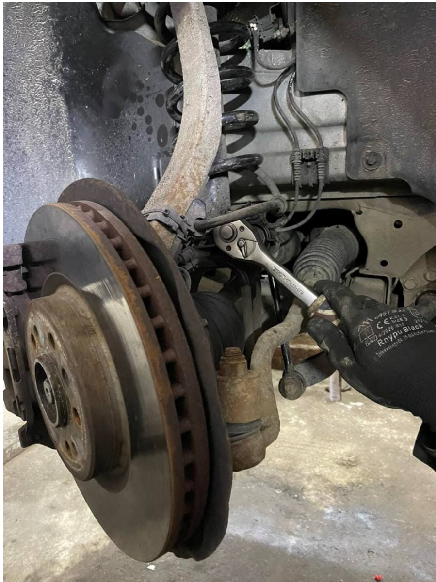
Рисунок 3.1. Початковий етап демонтажу маточини.
