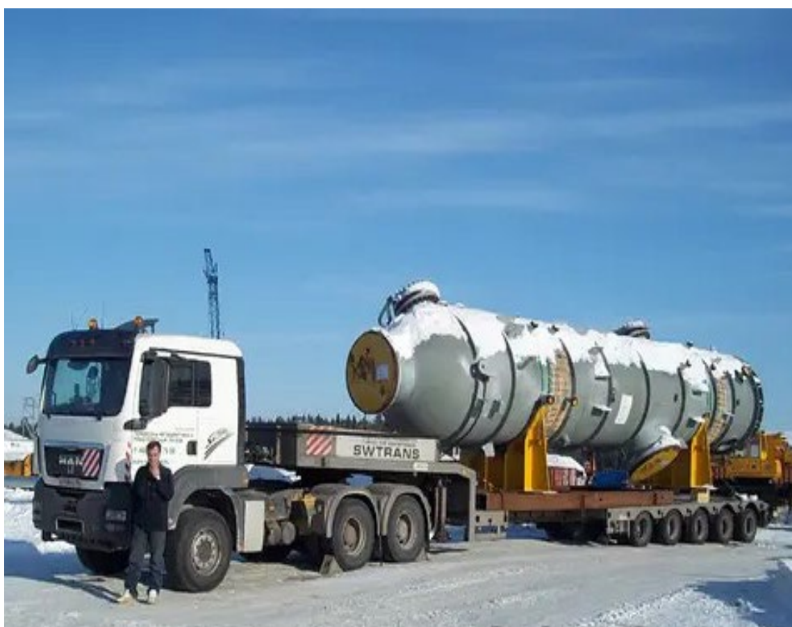
Рисунок 1.5. Приклад застосування металевих ложементів.
