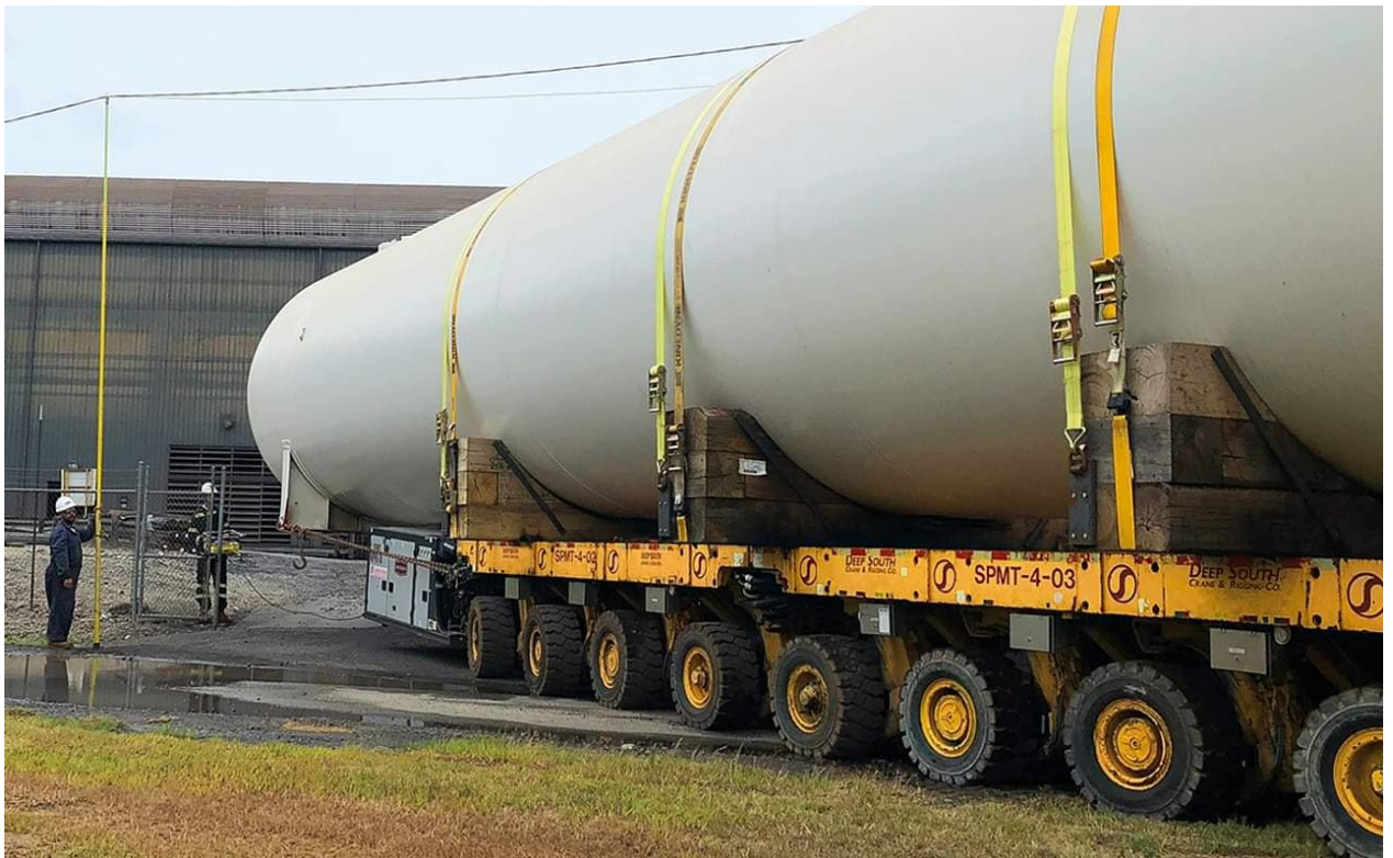
Рисунок 1.4. Приклад застосування дерев'яних ложементів.
