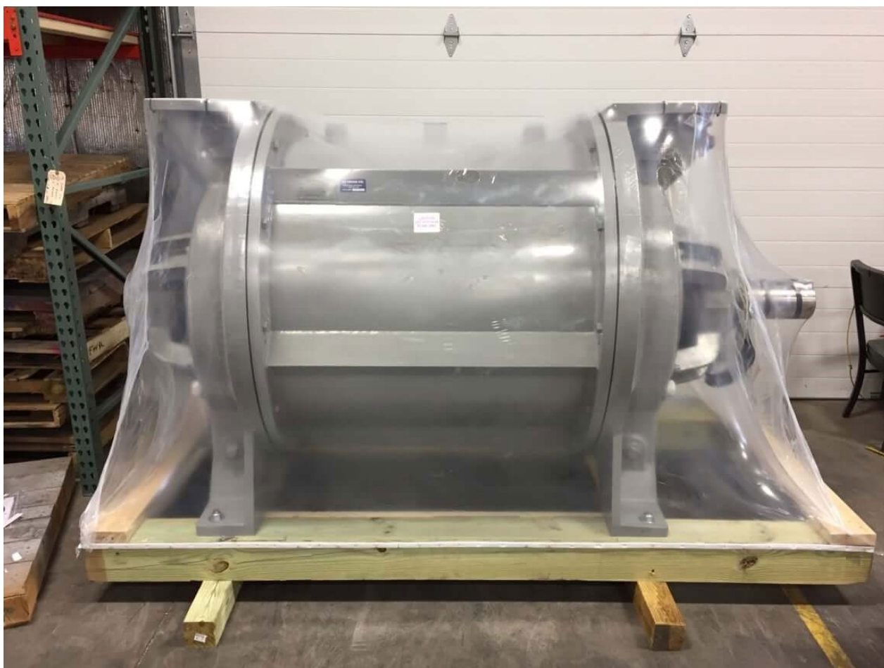
Рисунок 1.6. Пакування з застосування термозбіжної плівки.
