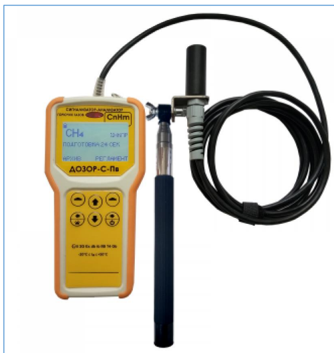
Рис. 2.2. Переносний однокомпонентний газоаналізатор ДОЗОР-С-Пв, призначений для вимірювання концентрації метану (CH 4 ) в атмосферному повітрі
