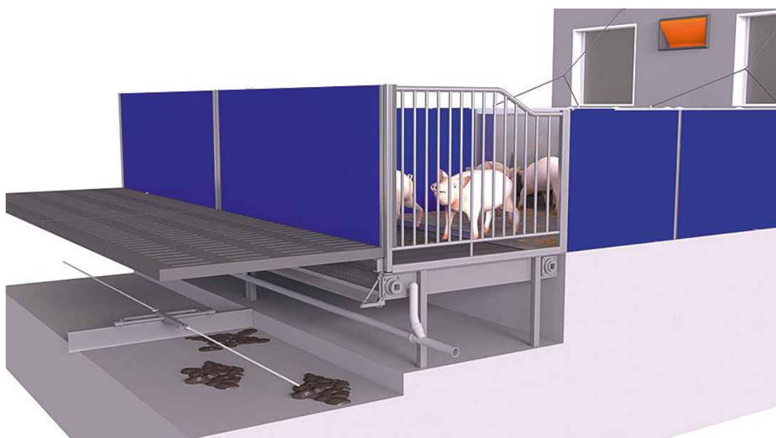
Рис. 3.4. Інноваційний бокс для утримання свиляр за концепцією Navito з інтегрованим санітарним модулем PigT
