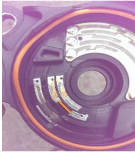
Рисунок 4.1 – Місце перемикання (мідним провідником) підгореної бігової доріжки датчика селектора.
