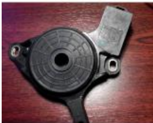
Рисунок 1.10 – Загальний вигляд несправного давача селектора АКПП.
