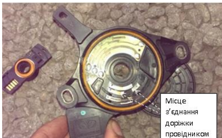
Рисунок 3.4 – Місце пошкодження електричної бігової доріжки
