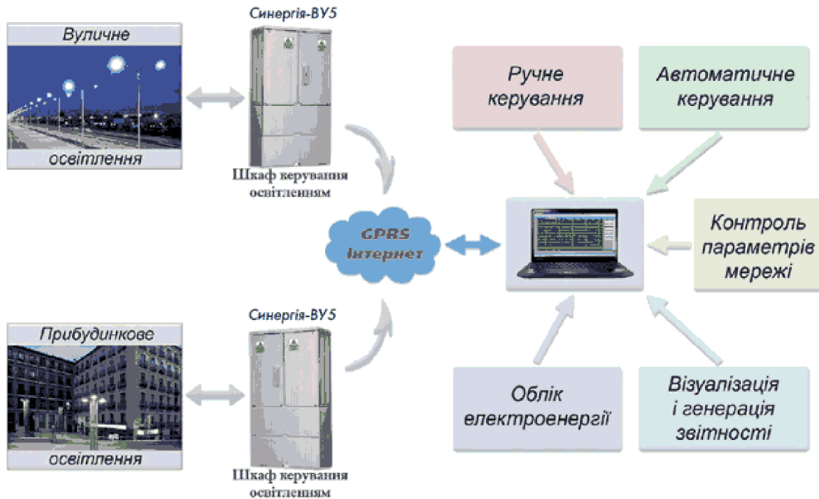
Рисунок 1.2 – Архітектура GSM-диспетчеризації освітлення
