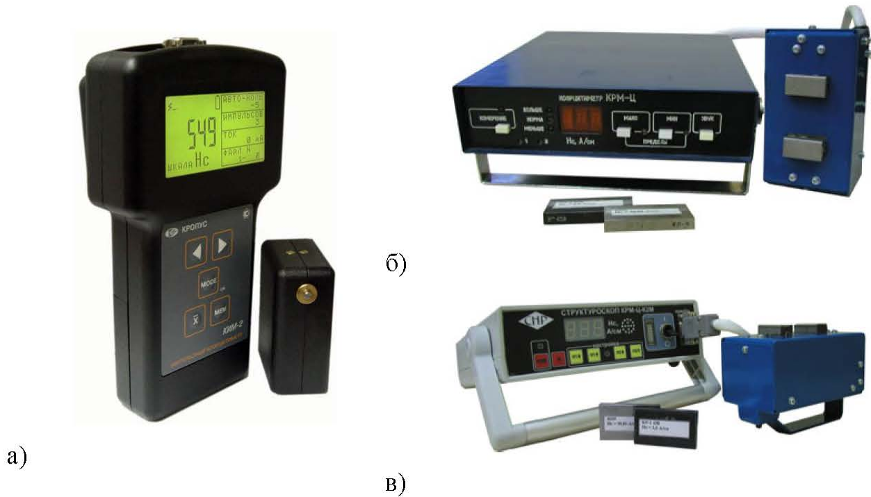
Рис. 2.3 Зовнішній вигляд коерцитиметрів: а – портативний імпульсний КІМ–2М; б – напівавтоматичний КРМ–Ц; в – магнітний структуроскоп КРМ–Ц–К2М
