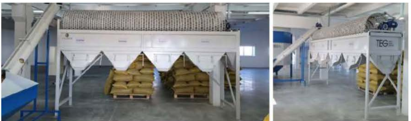
Рисунок 2.6 – Загальний вигляд вузла калібрування горіхів (а) та роторного калібратора (б), приклади (в) їх встановлення на виробництві.
