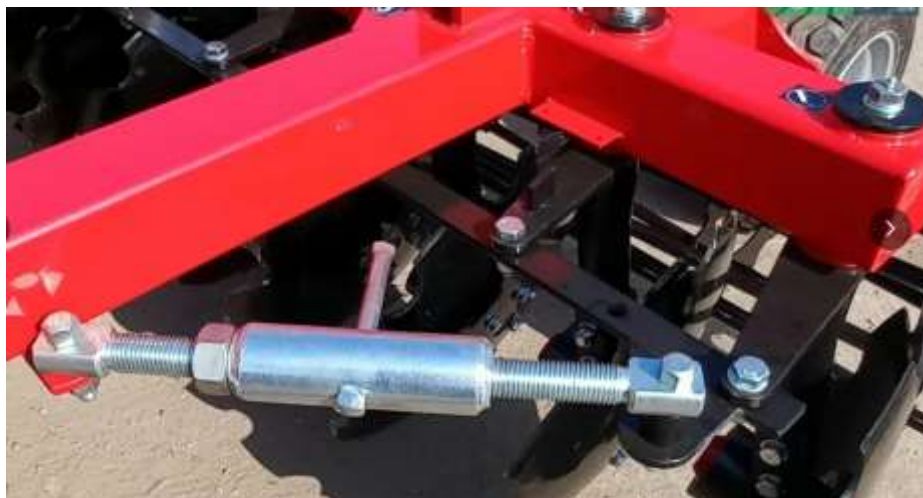
Рис.1.2 – Регулювальний механізм кута атаки агрегату Avalon 3,2
