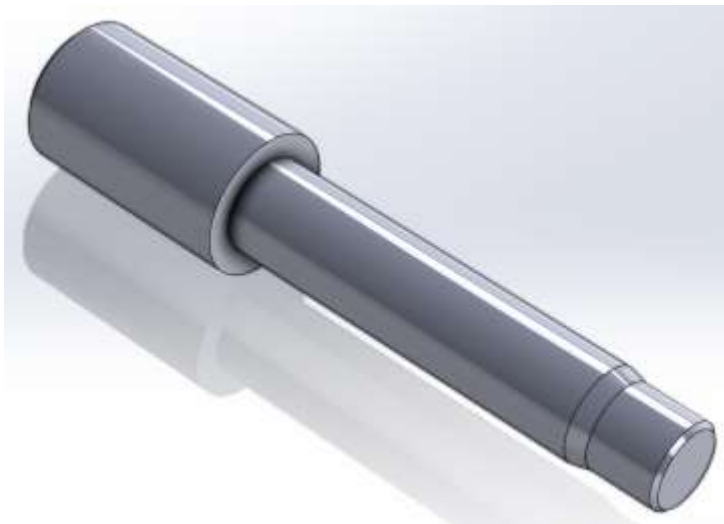
Рис. 3.1 – Твердотіла модель вісі опорного котка
