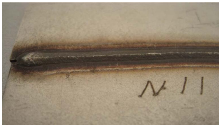
Рисунок 2.5 - Зовнішній вигляд шва із неякісним захистом від повітря
