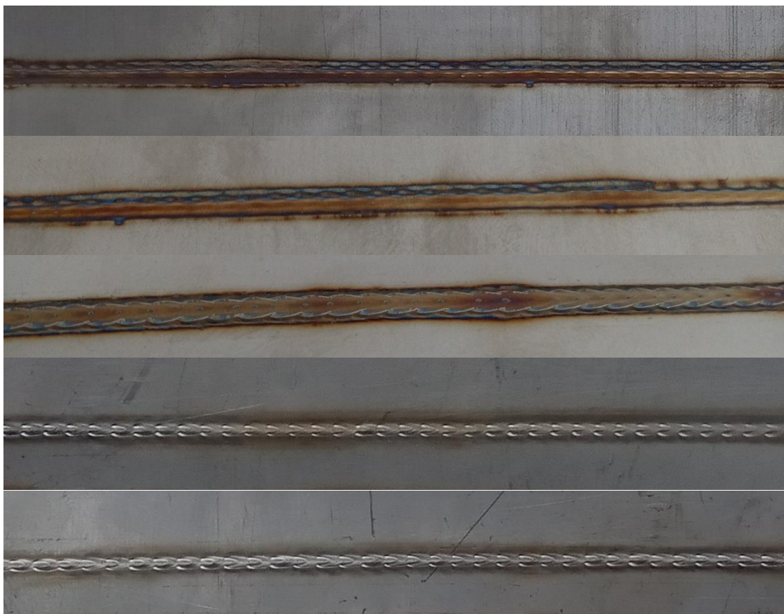
Рисунок 3.16 – Зварні шви, виконані в імпульсному режимі
