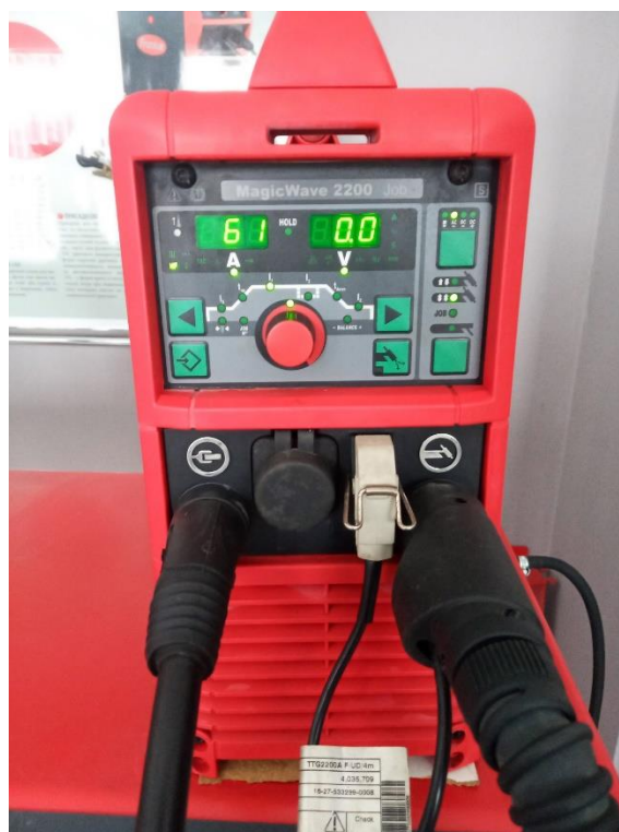
Рисунок 3.2 – Загальний вигляд джерела живлення MagicWave 2200 Job
