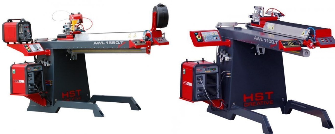
Рисунок 1.3 – Автоматичні установки для зварювання поздовжніх швів оболонок, труб і листів
