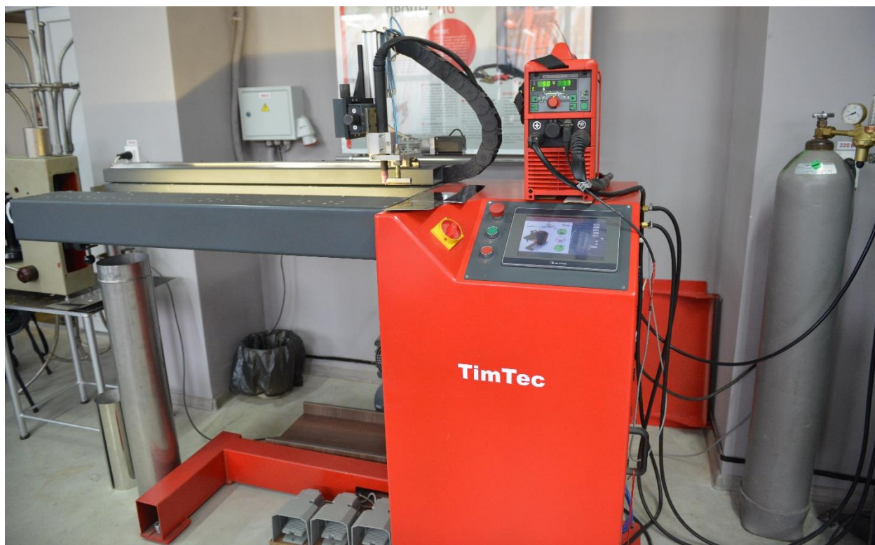
Рисунок 3.1 – Система AWS 1100 для автоматичного TIG зварювання повздожніх швів
