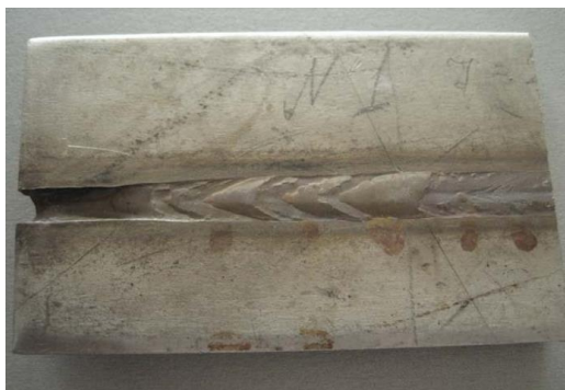
Рисунок 2.4 – Зовнішній вигляд шва, виконаного з «висячою» присадкою
