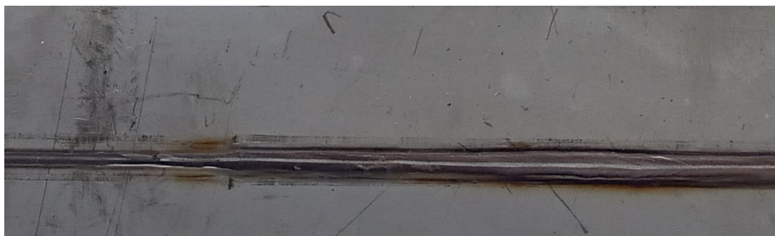
Рисунок 3.12 – Різна ширина зварного шва
