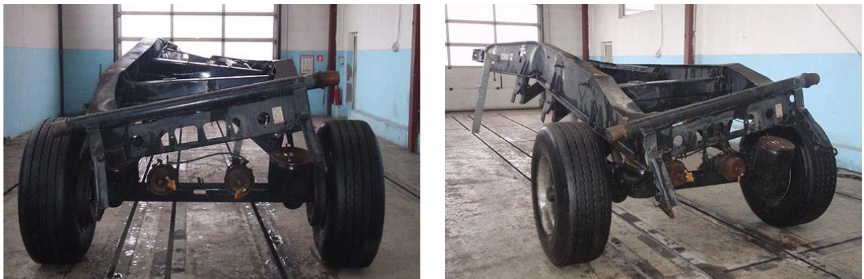
Рисунок 1.4 – Випадки прогину рам причепів
