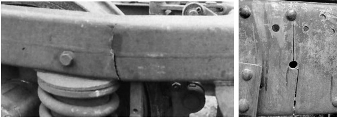
Рисунок 2.1 – Поперечні тріщини несучих конструкцій рами вантажного автомобіля
