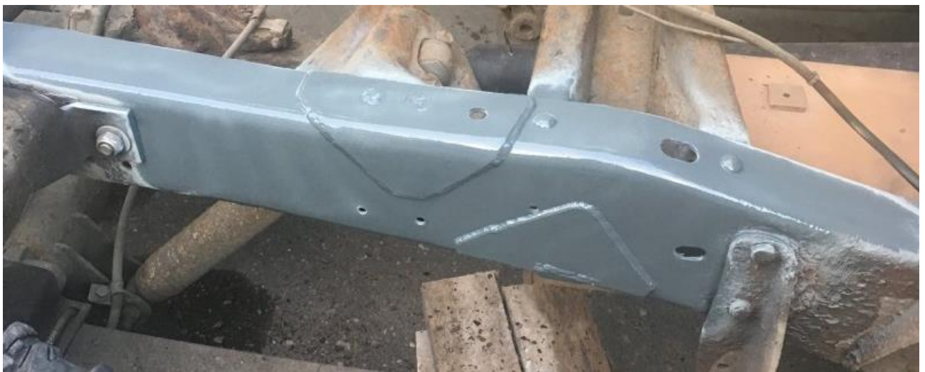
Рисунок 1.12 – Приклади підсилення рам напівпричепів
