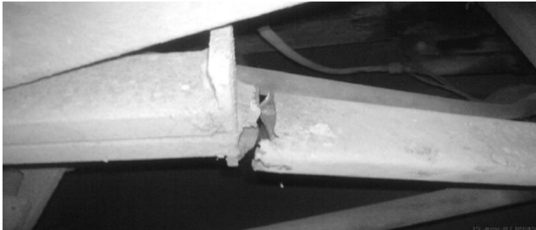
Рисунок 1.6 – Тріщини в місцях з'єднання прямокутних профілів рамного каркаса автобуса ЛАЗ
