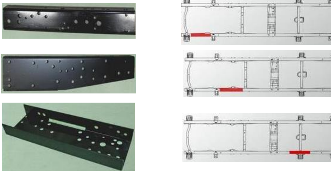
Рисунок 1.10 – Підсилюючі елементи рами та схеми їх монтажу
