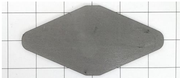
Рисунок 1.8 – Заводська підсилювальна накладка
