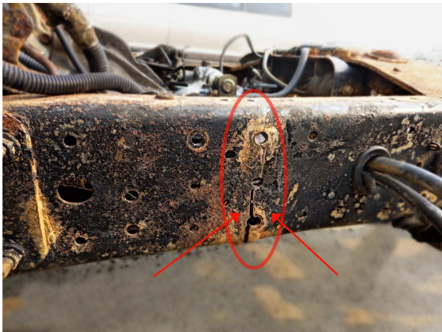
Рисунок 1.5 – Розвиток тріщини по концентратора напружень (отворах) в рамі
