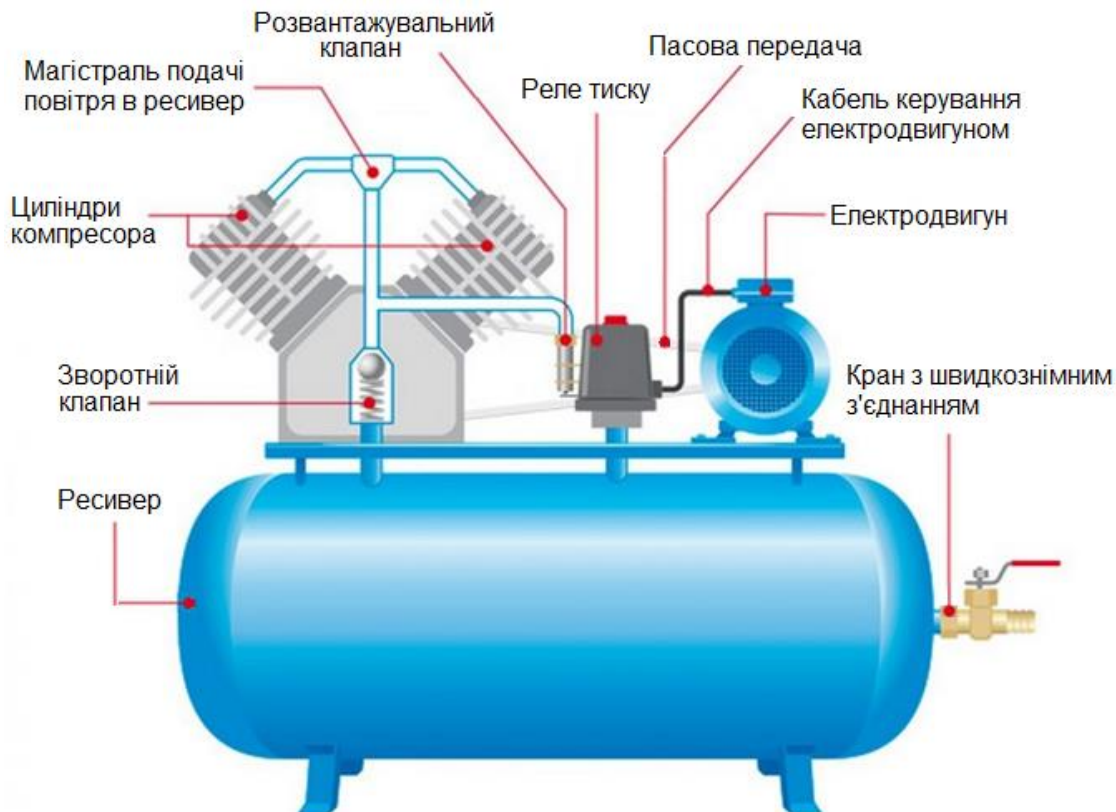
Рисунок 1.1 – Конструктивна схема поршневого пневматичного компресора
