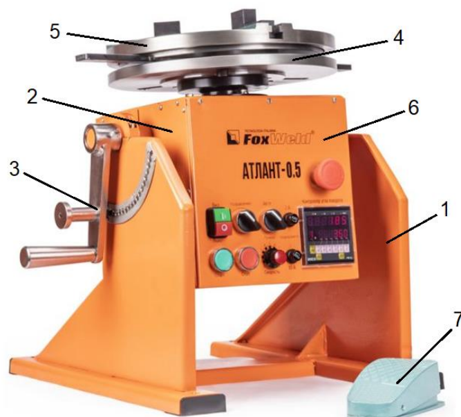
Рисунок 2.3 – Загальний вигляд зварювального обертача АТЛАНТ
