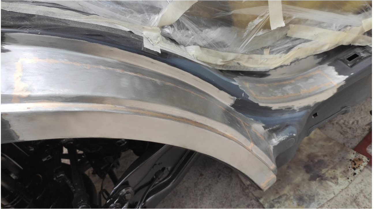
Рисунок 3.2 – Ремонт арок коліс, виконаний методом MIG-паяння
