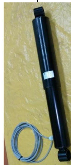
Рисунок 3.5 – Гідравлічно ослаблений амортизатор
