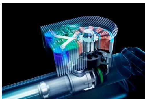
Рисунок 1.3 – Регенеративна підвіска GenShock
