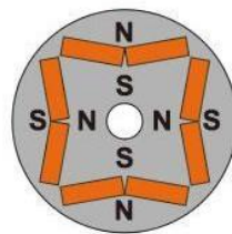
Рисунок 1.15 – Ротор синхронного двигуна із вбудованими магнітами
