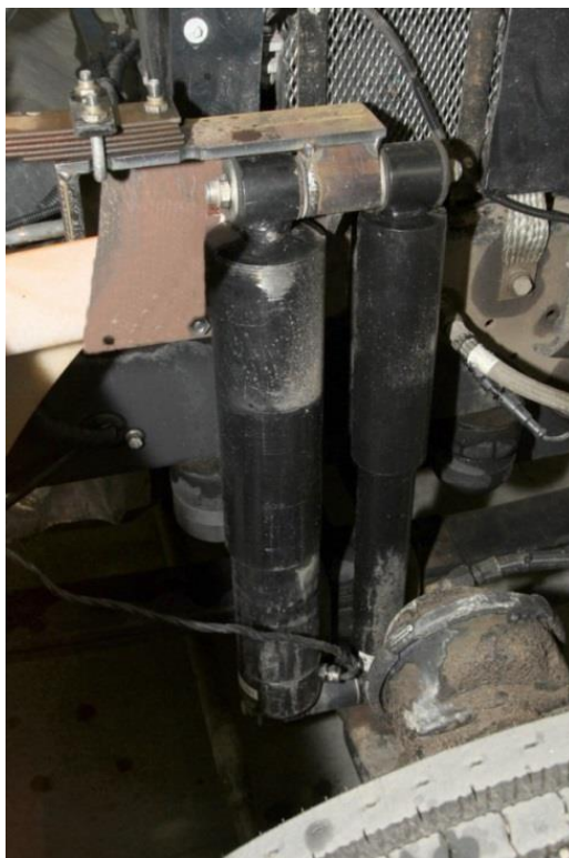
Рисунок 3.4 – Зовнішній вигляд вузла, що демпфує 1 – амортизатор із регенеративним ефектом; 2 – ослаблений гідроамортизатор
