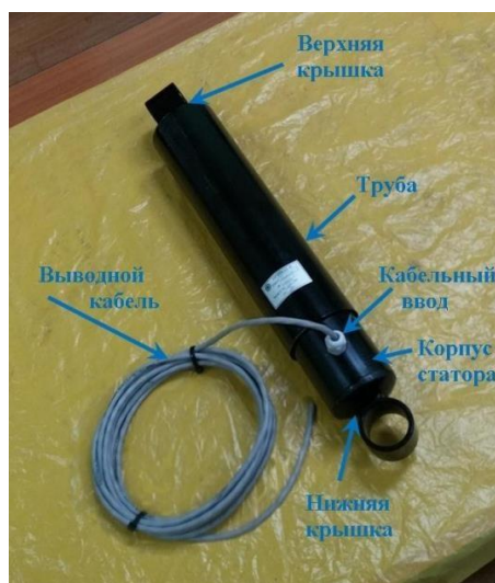
Рисунок 3.5 – Гідравлічно ослаблений амортизатор
