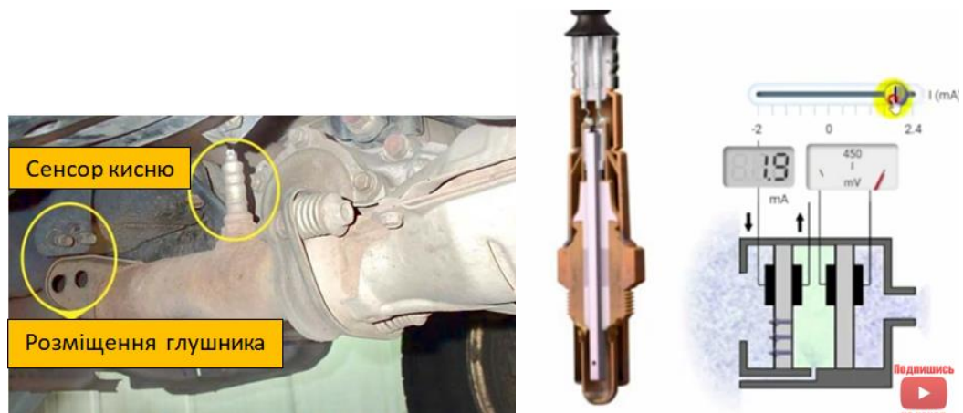
Рисунок 3.4 – Розміщення та конструктивно-технологічна схема широкопсмугового сенсора кисню.
