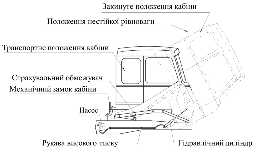
Рисунок 1.3 – Схема розташування елементів гідравлічного механізму перекидання кабіни
