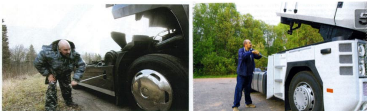
Рис. 2.12 Процес перекидання кабіни оператором
