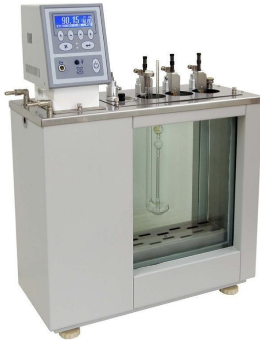
Рисунок 3.7 - Термостат рідинної VIC-T-03 для визначення кінематичної в'язкості нафтопродуктів типу ВПЖ -2 або ВПЖ-4
