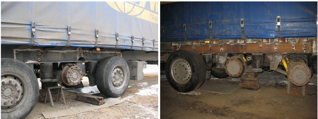
Рисунок 1.8 – Етапи ремонту та підсилення рами напівпричепи:
