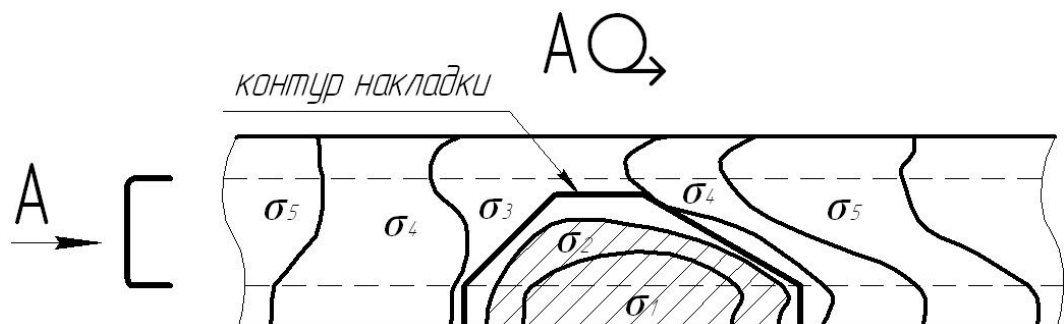
Рисунок 3.7 – Поля напружень на ділянках рами із встановленими підсилюючими накладками
