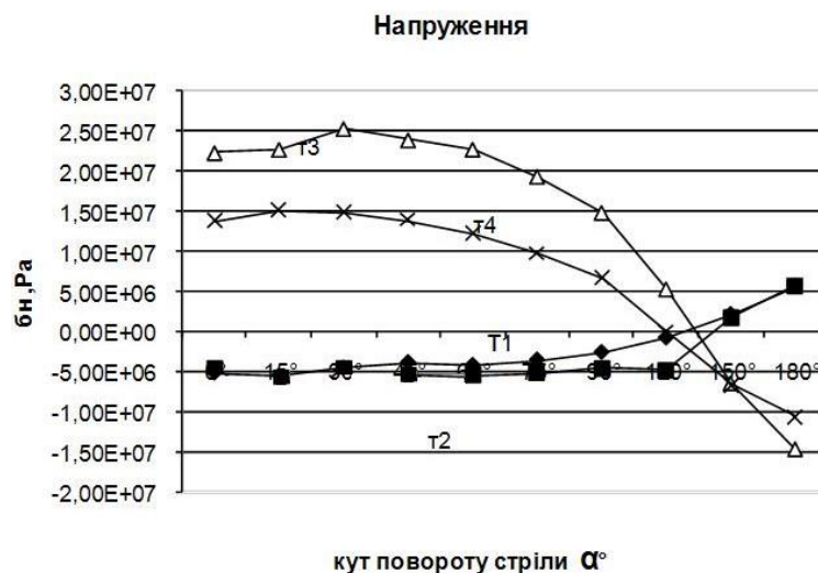
Рисунок 3.4 – Графік впливу напружень в матеріалі рами в точках на шляху передбачуваної тріщини від величини кута повороту стріли
