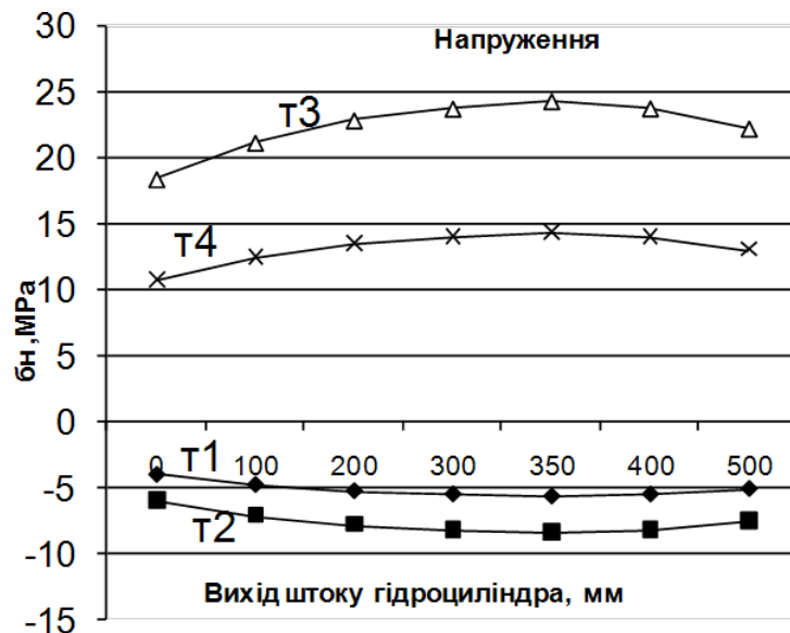
Рисунок 3.6 – Графік значень напружень у матеріалі рами, які утворюються в місцях передбачуваної тріщини залежно від величини положення штока гідроциліндра стріли
